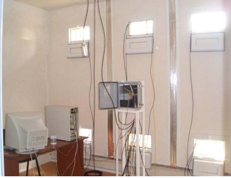
Şekil 4.11 Datalogger kurulumu ve sensörlerin yerlerinin tespit edilip takılması.
