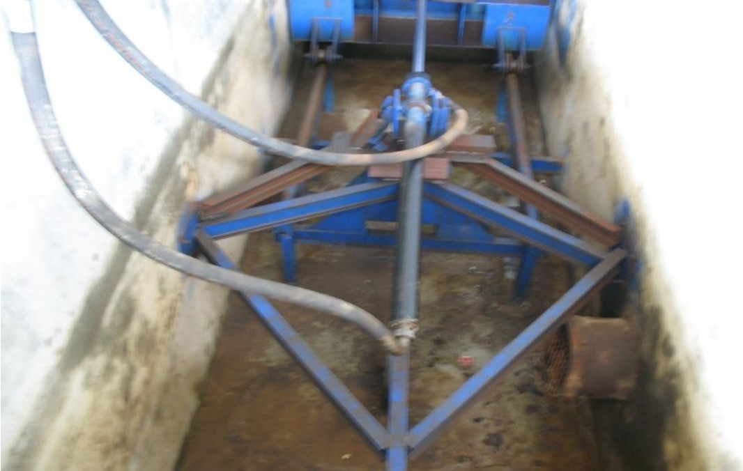
Şekil 3.7 : İ.T.Ü. Hidrolik Laboratuvarı Dalga Üretici Piston Arkadan Görünümü
