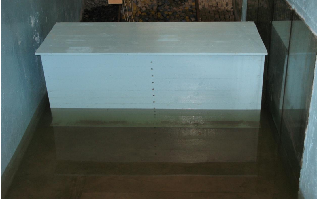
Şekil 3.10 : İ.T.Ü. Hidrolik Laboratuvarında İnşa Edilen Korumasız Keson Yapı.
