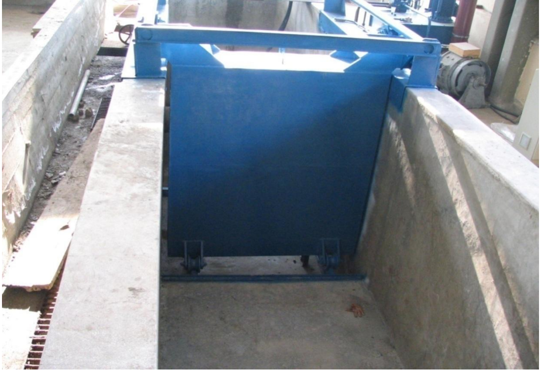
Şekil 3.8 : İ.T.Ü. Hidrolik Laboratuvarı Dalga Üretici Piston Önden Görünümü
