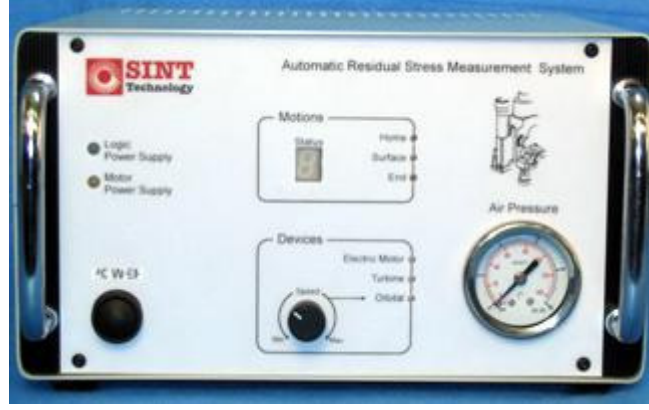
Şekil II.23. MTS 3000 Delik Delme Aracının Kontrol Ünitesi [14]
