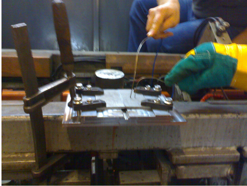
Şekil III.7. Deney Malzemesi Üzerinde Termokupul Ölçüm İşleminin Yapılması
