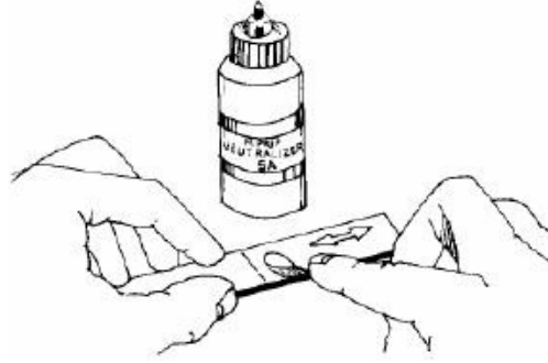
Şekil III.28. Numune Yüzeyinin Temizlenmesi
