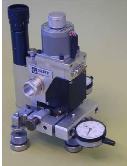
Şekil II.22 MTS 3000 Delik Delme Aracının Mikroskopla Odaklama Aparatlarının Montaj Resmi [14]
