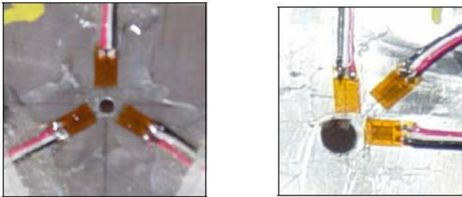
Şekil II.29. Type A Delta Oryantasyon Type B Konfigürasyon (ASTM Tespiti) [16]
