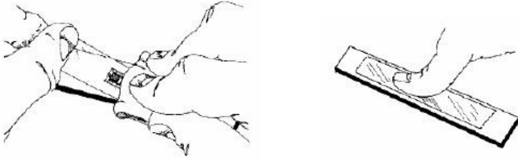
Şekil III.30. Numuneye Strain Gage' in Bağlanması
