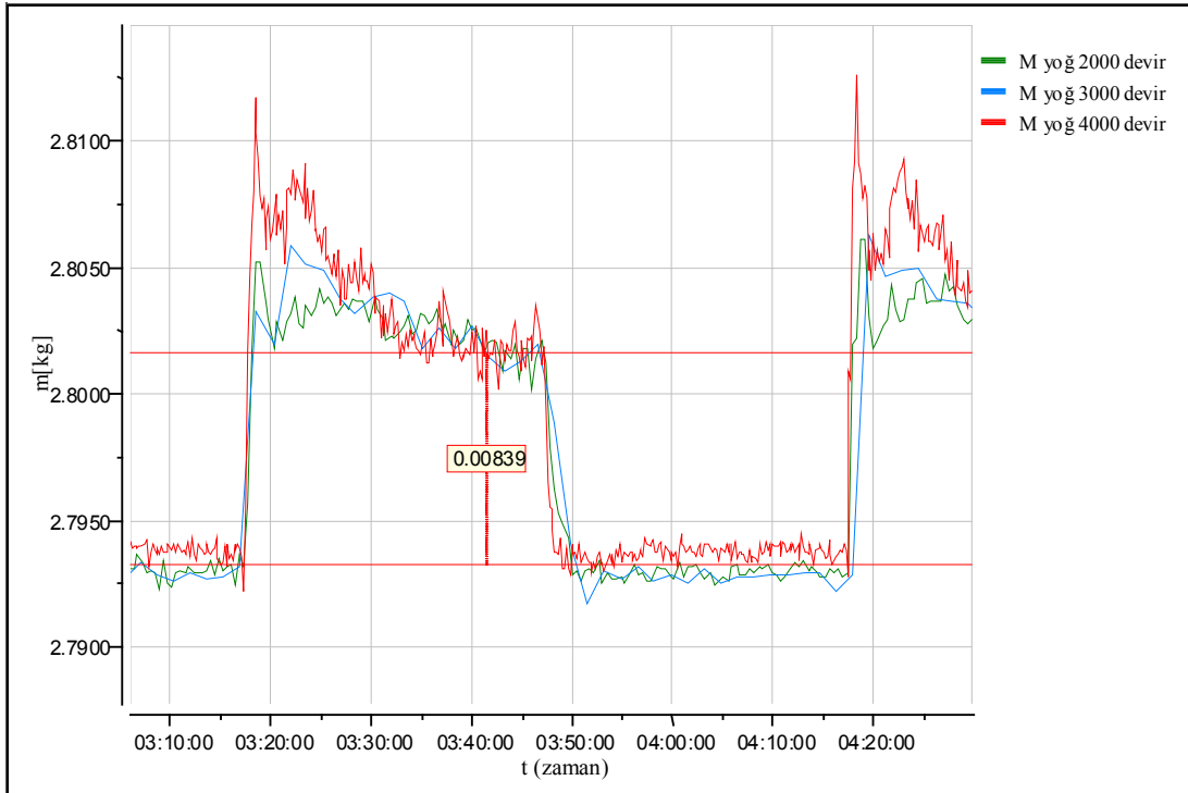
Şekil 3.24 : VCC %50 çalışma farklı devirlerde buharlaştırıcı şarj miktarı.
