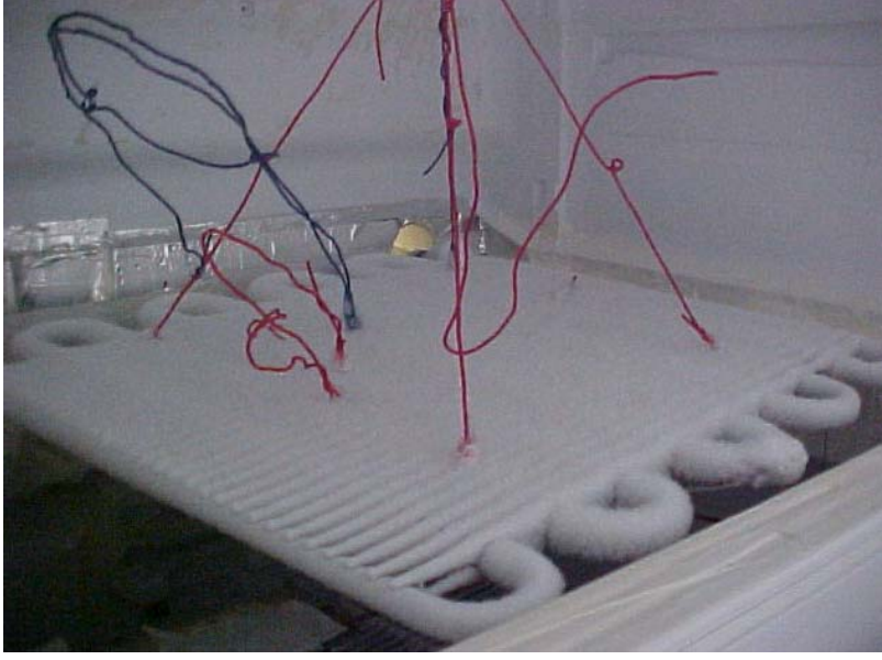
Şekil 3.6 : Aşırı karlanma gözlenen 1. raf
