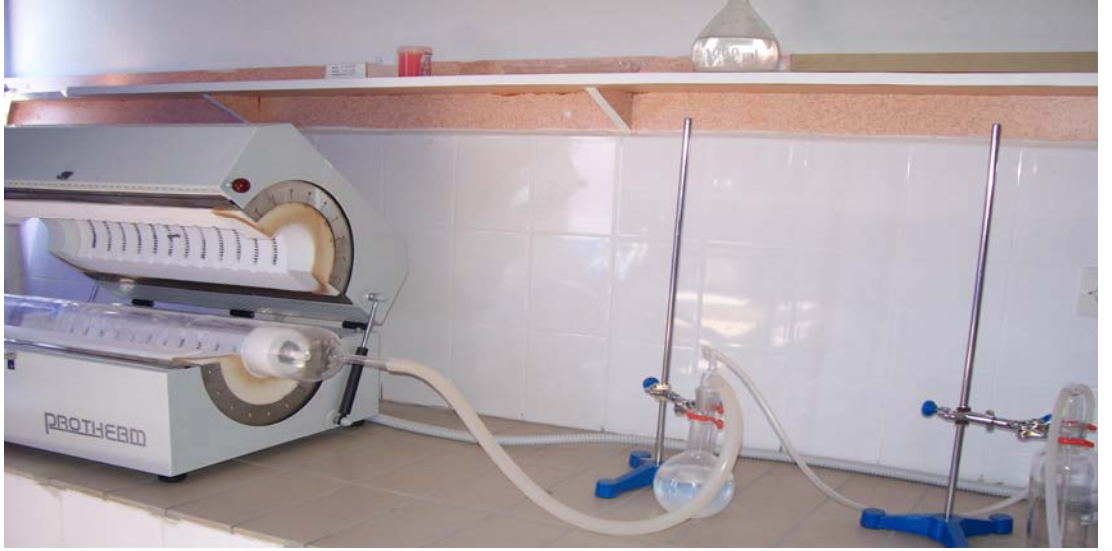
Şekil -8 Aktivasyon fırını ile su ve gaz tutucu düzenek
