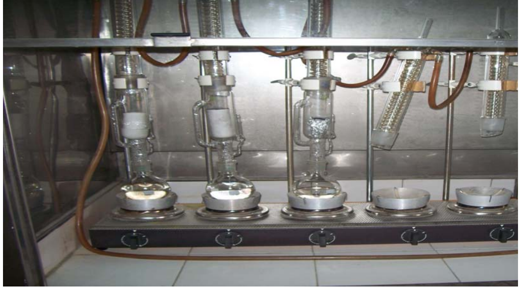
Şekil-4 Soxlet aparatu
