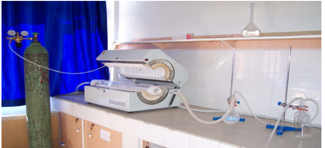
Şekil -9 Aktivasyon fırını ile su ve gaz tutucu düzenek
