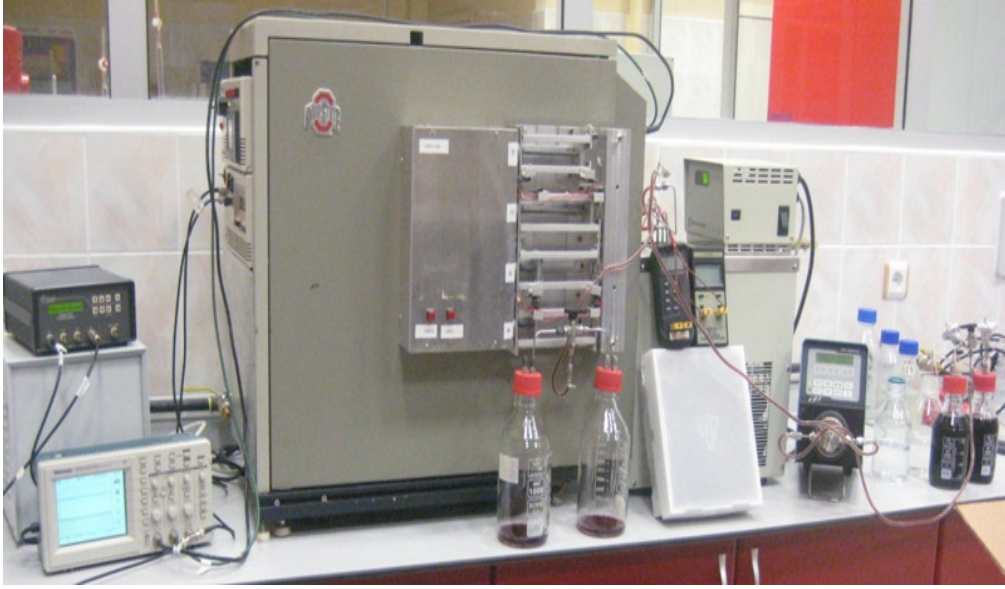
Şekil 3.1. Deneylerde kullanılan laboratuvar ölçekli PEF sistemi.
