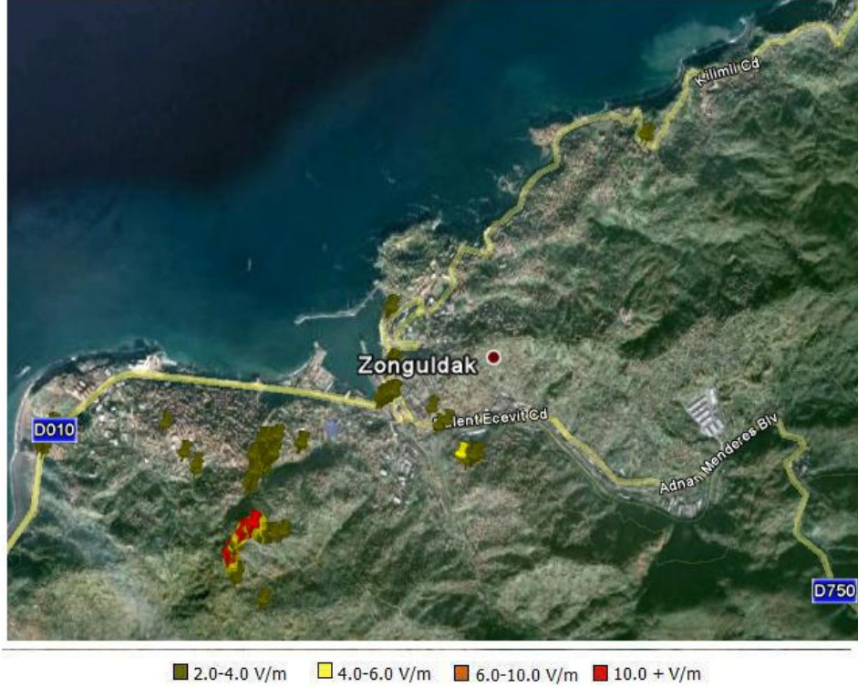
Şekil 4.10 E- alan şiddeti değeri 2 V/m (zeytin) ve üzerinde olan yerler.
