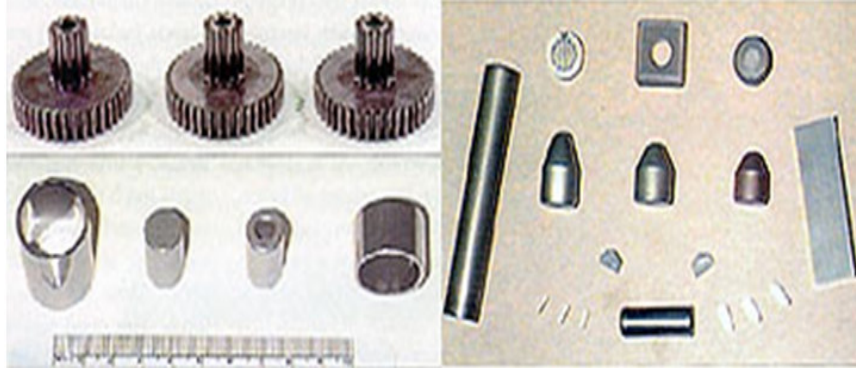
Şekil 2.11. Mikrodalga sinterleme ile üretilmiş parçalar (Agrawal 1999).
