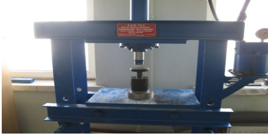
Şekil 3.4. Şekillendirme işleminde kullanılan hidrolik pres.
