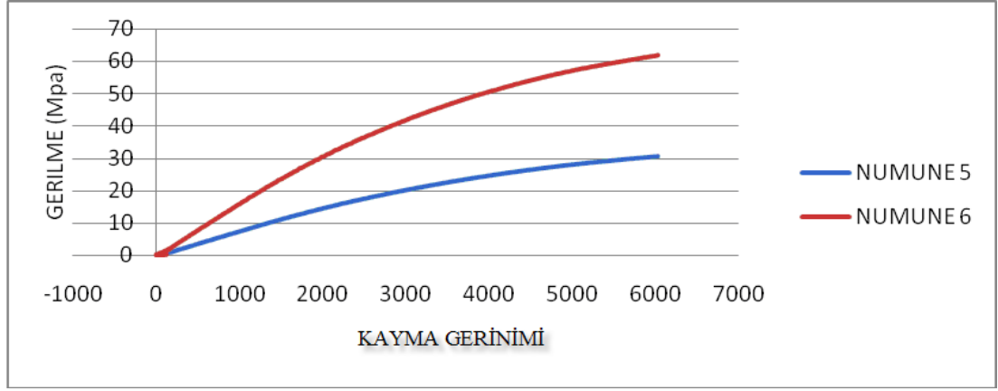
Şekil 3.10 : Gerilme – kayma gerinimi deęiřimi ( \pm 45^\circ ynelimli elyaf)
