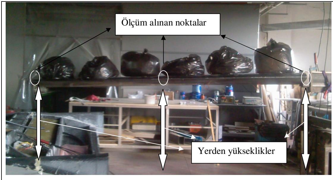
Şekil 5.5 : Yüklenen kum torbaları ve kanat
