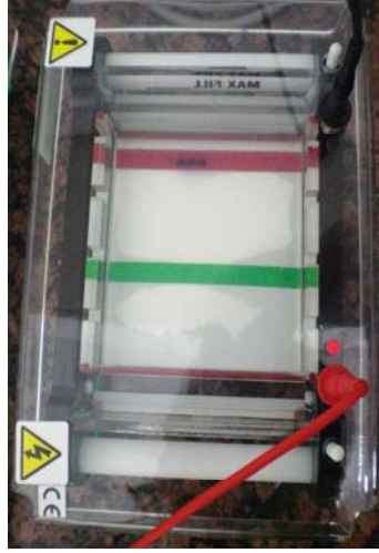
Şekil 2.4 Agaroz jel elektroforezi (Consort EV265)
