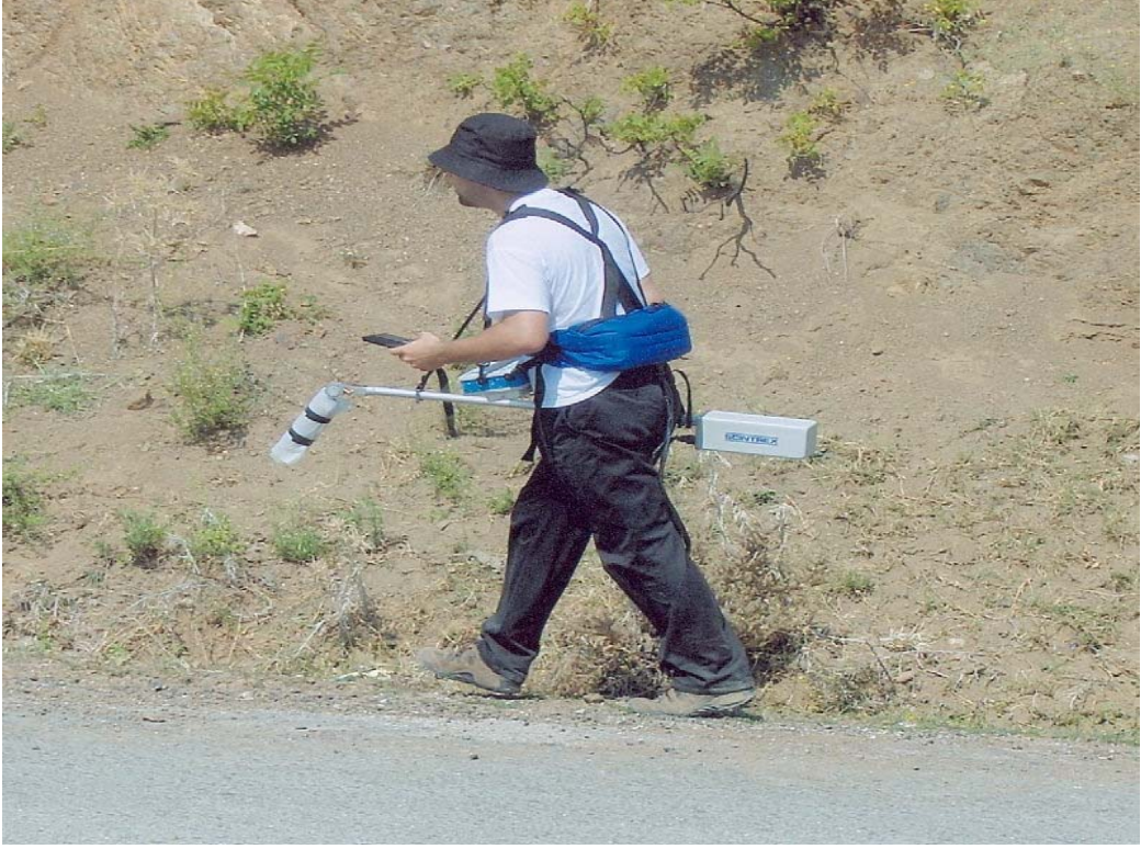
Şekil 3.4 Smartmag (SG-4) manyetometresi ile manyetik ölçü alımı
