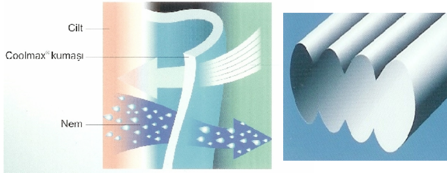
Şekil 6.2. Coolmax kumaşını oluşturan dört kanallı liflerin görünümü ( http://www.coolmax-thermolite.com/coolmax/coolmax.html , 2008; http://www.advansa.com , 2008)
