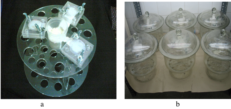
Şekil 3.9 Fümigant etki deneme düzeneği; a) Pleksiglas raf, b) Desikatör.
