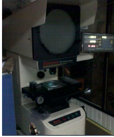
Şekil III.6 Deneyde kullanılan iki boyutlu profil projeksiyon ölçüm cihazı
