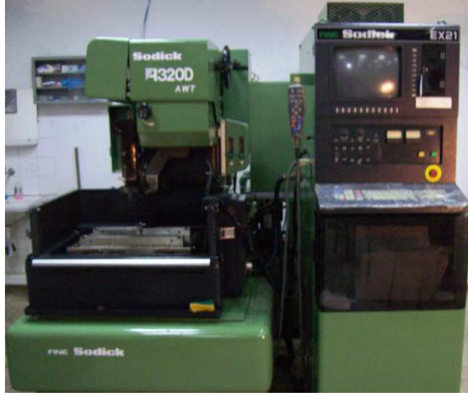
Şekil III.2 Sodick A320D/EX21 Model CNC Tel Erozyon Tezgahı
