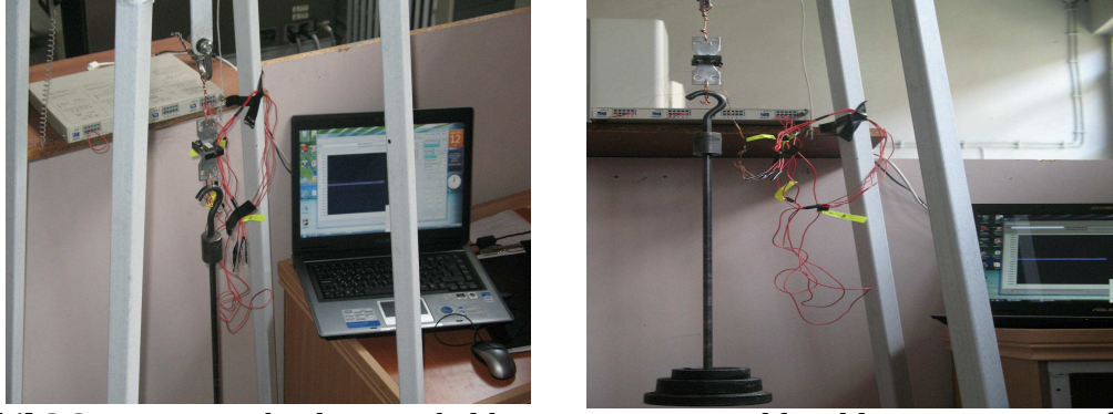
Şekil 3.21. Temas Pabuçları için kalibrasyon eğrisinin elde edilmesini gösteren fotoğraf görüntüleri
