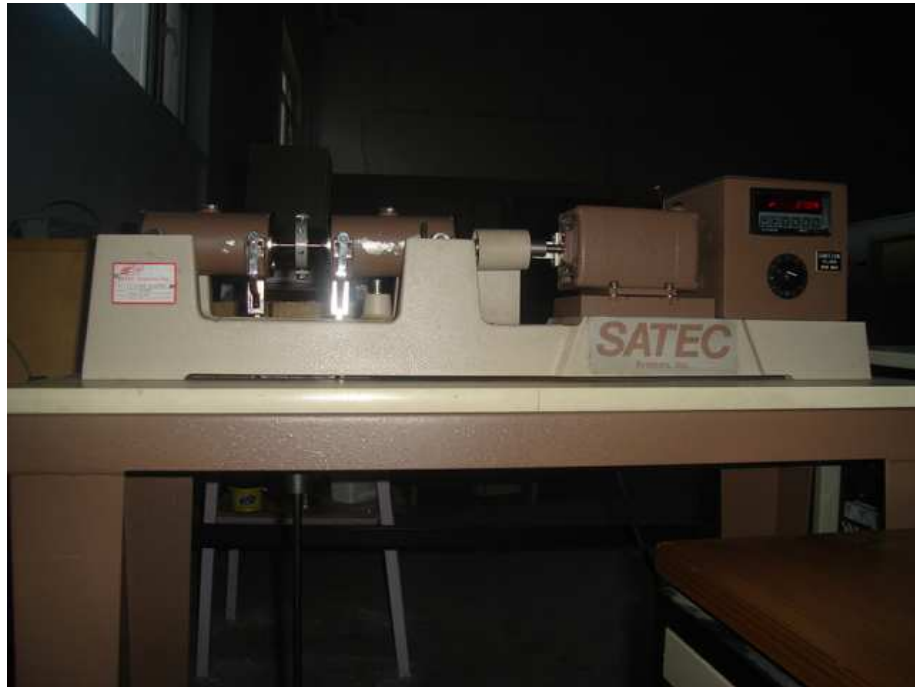
Şekil 3.10. Döner eğilmeli yorulma test ünitesinin fotoğraf görüntüsü
