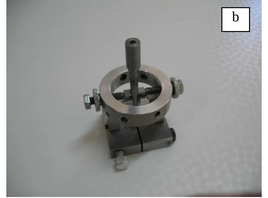
Şekil 3.8.a.b. Döner eğilmeli test cihazı için, sürtünmeli temas test düzeneği üzerine temas pabuçlarını yerleştirme aparatı fotoğraf görüntüsü
