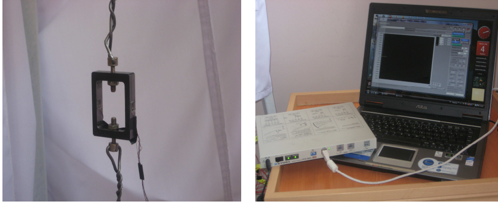
Şekil 3.18. Yük uygulama halkası için kalibrasyon eğrisinin elde edilmesini gösteren fotoğraf görüntüsü
