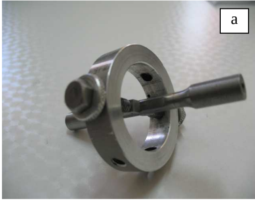
Şekil 3.8.a.b. Döner eğilmeli test cihazı için, sürtünmeli temas test düzeneği üzerine temas pabuçlarını yerleştirme aparatı fotoğraf görüntüsü
