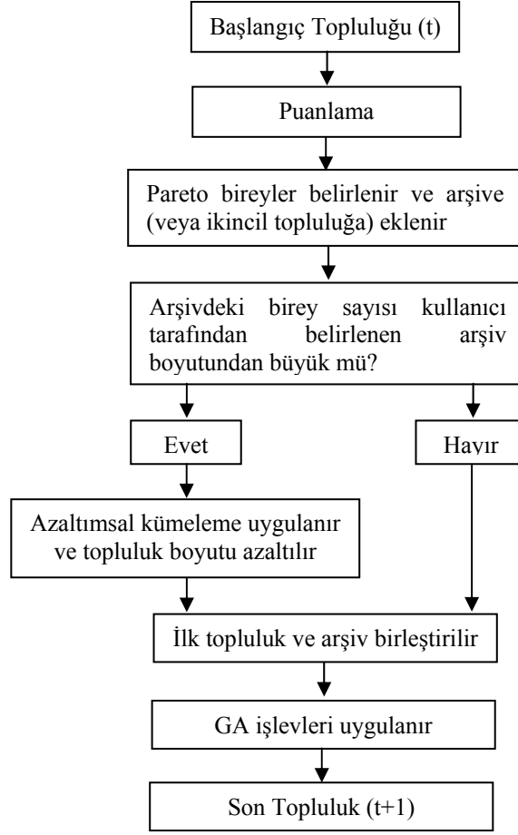
Şekil 4.3. DOPGA elitizm mekanizmasının blok diyagramı
