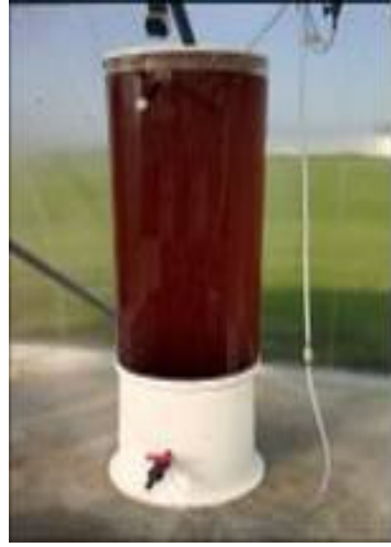
Şekil 2.8 Fotobiyoreaktörde Porphyridium sp. üretimi ( www.activalg.fr/img )
