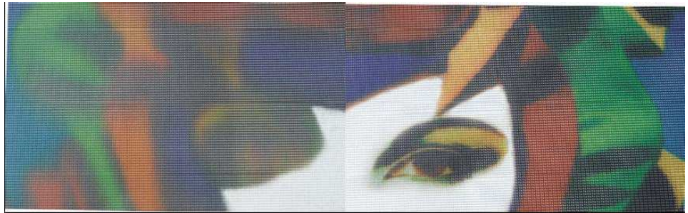
Şekil 2.19 Ön işlemin çalışma prensibi. Solda – ön işlem görmemiş substrat, sağda – ön işlem görmüş substrat (Provost et al., 2004).
