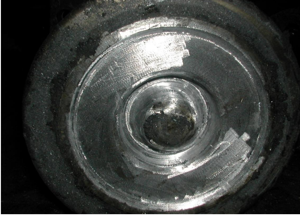
Şekil II.18. Kalıp yüzeyinin sıcaklığın etkisi ile liflenmesi.
