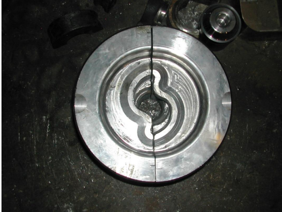
Şekil II.26. Eğim ve açının görüldüğü bir kalıp.
