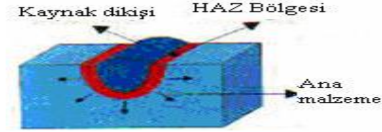
Şekil II.15. Dolgu kaynağında ITAB'ın şematik gösterimi.
