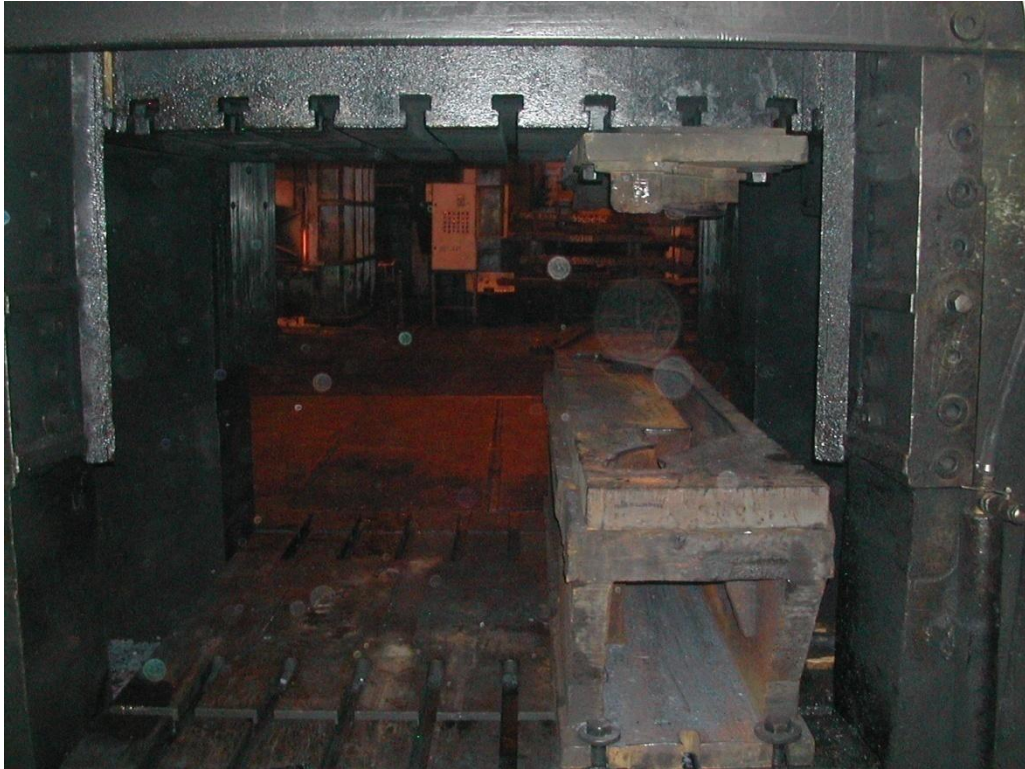
Şekil II.28. Çapak kesme kalıbının tezgâha montaj edilmiş hali.
