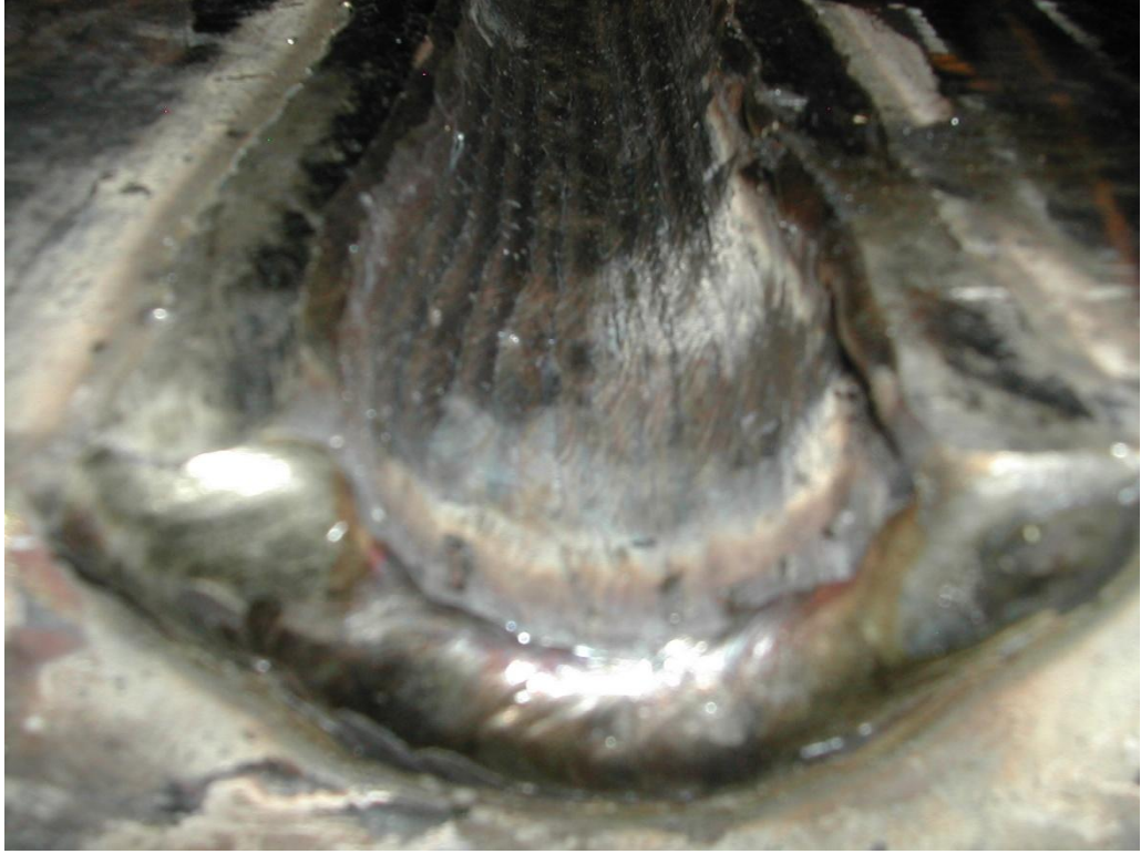
Şekil II.19. Çöken bir kalıbın kaynakla tashih edilmiş bir görünümü
