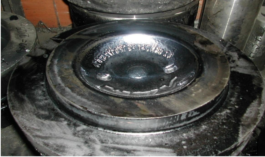
Şekil II.21. Yazı diplerindeki liflenme.
