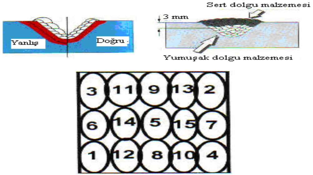
Şekil II.16. Dolgu kaynağının uygulanmasında dikkat edilecek noktalar.
