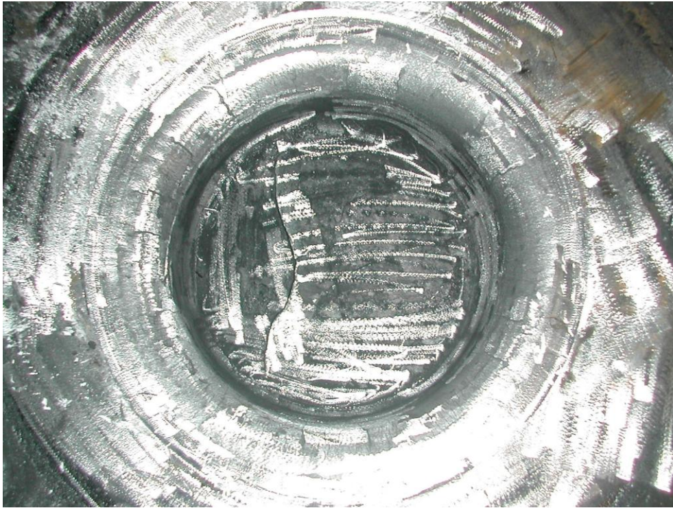
Şekil II.13. Ezme kalıbının aşırı yük ve sıcaklığa maruz kalması sonucunda oluşan çatlak.
