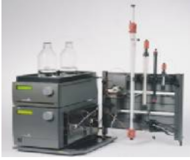
Şekil 2.16 AKTA Amersham Bioscience firmasına ait FPLC cihazı ve kısımları
