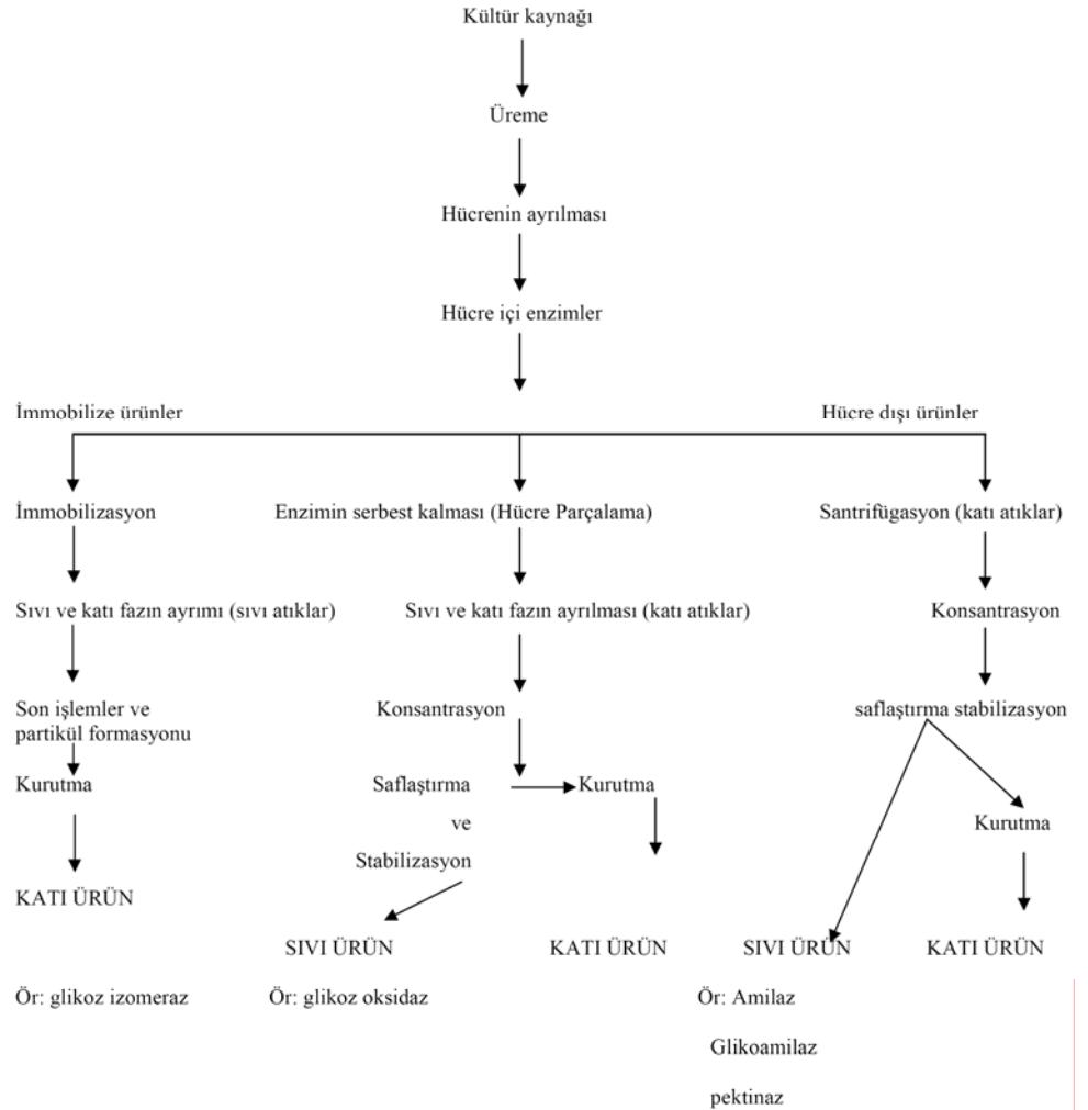
Şekil 2.11 Enzim üretimi ve alt akım proseslerinin genel şeması (Panke ve ark., 2002).
