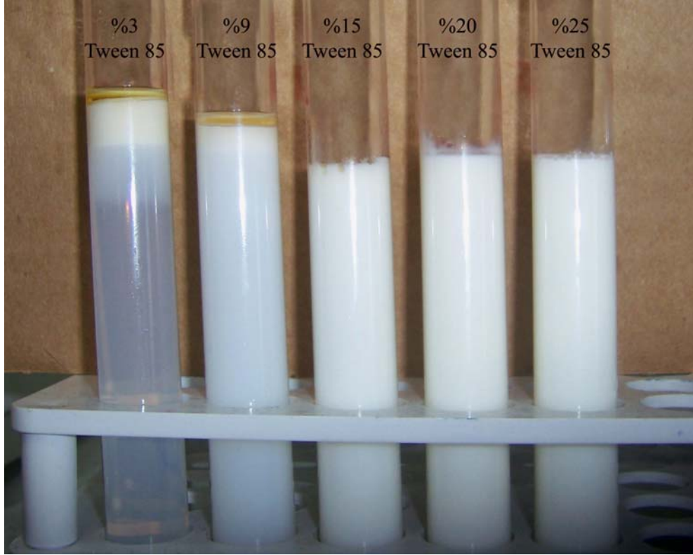
Şekil 35. Ham kanola yağı ve Tween 85 yüzey aktif maddesi ile hazırlanan metal kesme sıvısı
