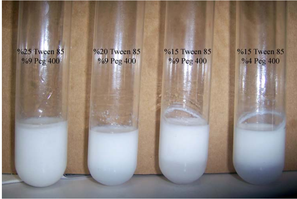
Şekil 37. Ham kanola yağı ve Tween 85-Peg 400 yüzey aktif madde karışımlarından elde edilen metal kesme sıvıları
