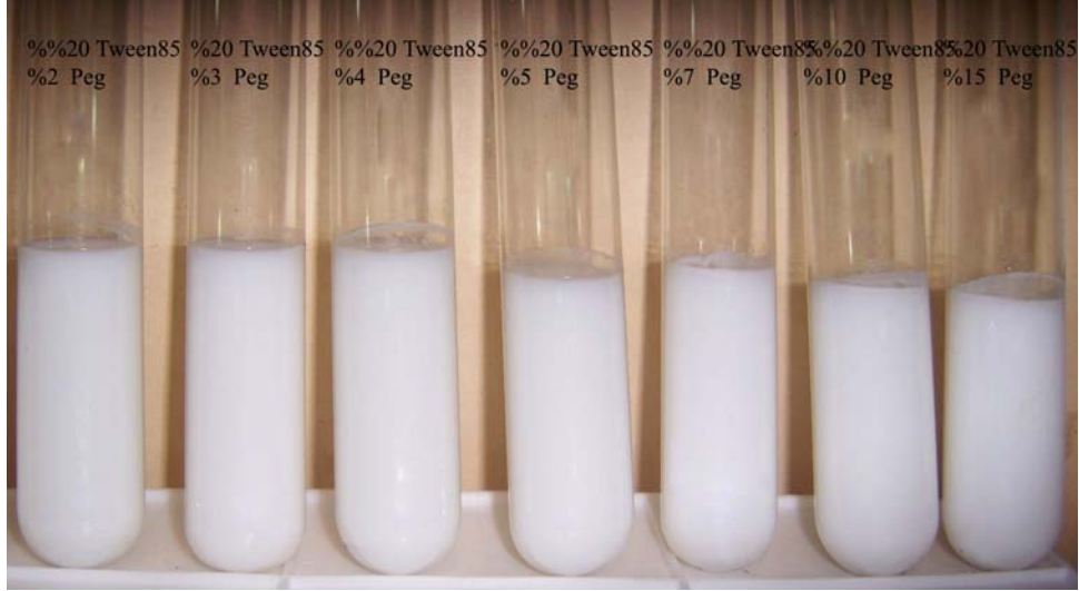
Şekil 31. Ham ayçiçeği yağı ve Tween 85-Peg 400 yüzey aktif madde karışımlarından elde edilen metal kesme sıvıları
