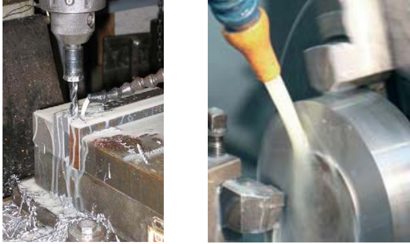
Şekil 1. Metal kesme sıvılarının metal kesme esnasında kullanımı.
