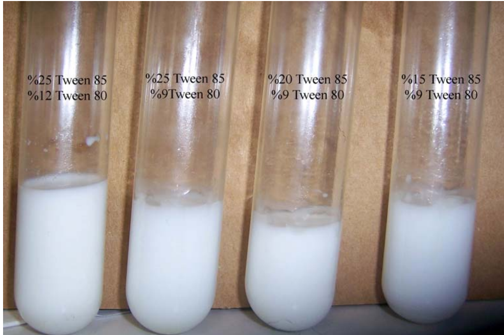
Şekil 36. Ham kanola yağı ve Tween 85-Tween 80 yüzey aktif madde karışımlarından elde edilen metal kesme sıvıları
