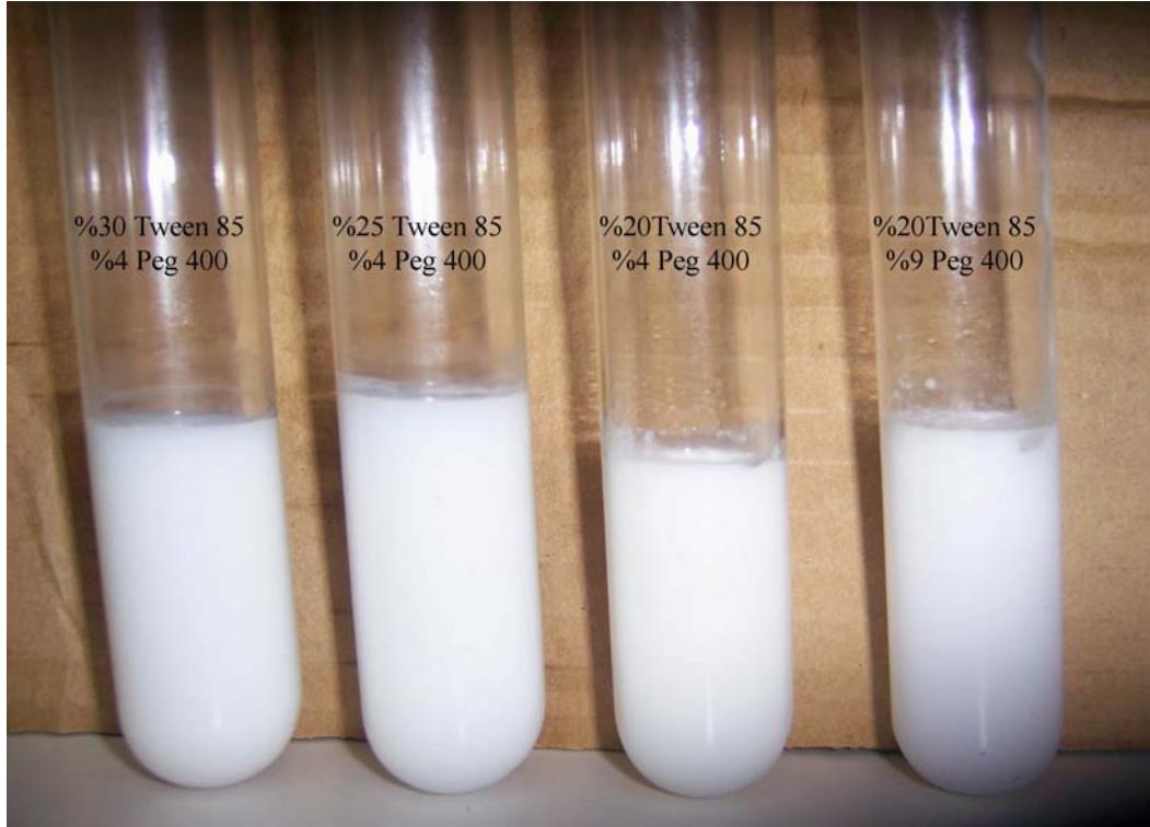
Şekil 34. Rafine kanola yağı ve Tween 85-Peg 400 yüzey aktif madde karışımlarından elde edilen metal kesme sıvıları
