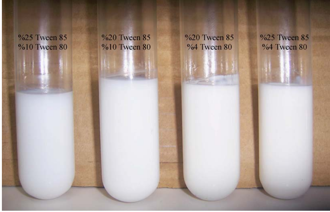
Şekil 33. Rafine kanola yağı ve Tween 85-Tween 80 yüzey aktif madde karışımlarından elde edilen metal kesme sıvıları
