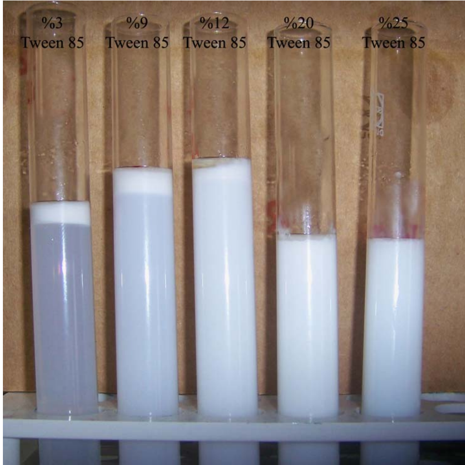
Şekil 32. Rafine kanola yağı ve Tween 85 yüzey aktif maddesi ile hazırlanan metal kesme sıvısı
