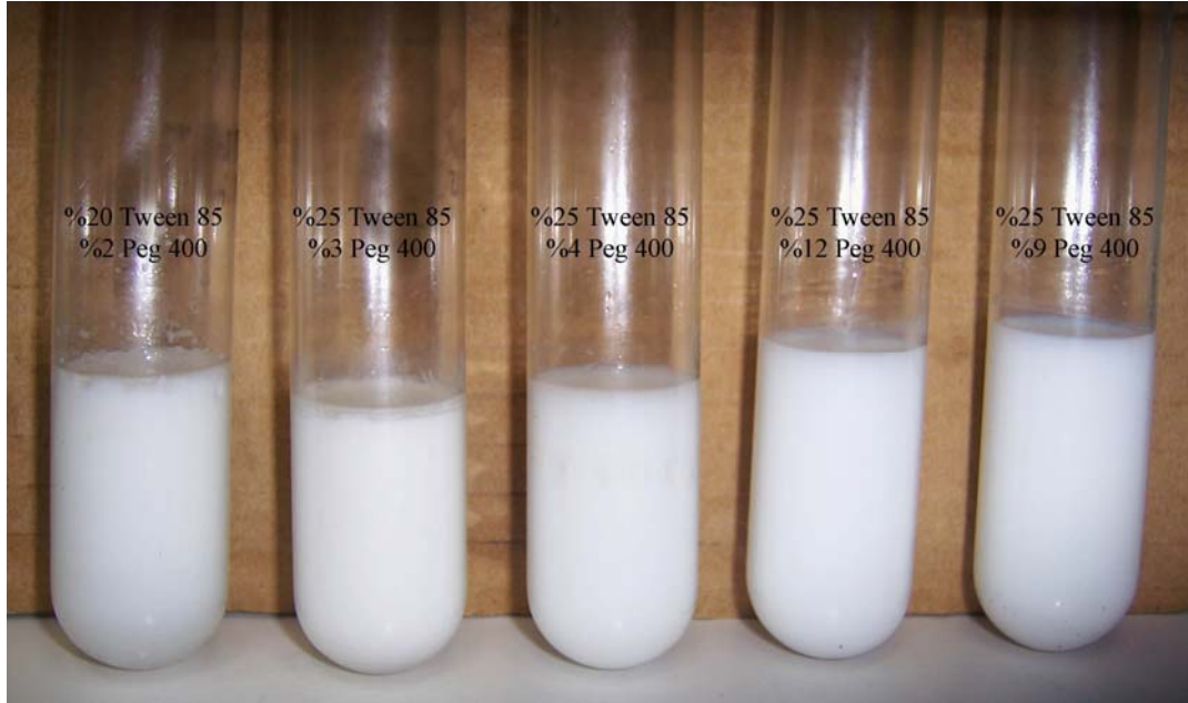
Şekil 28. Rafine ayçiçeği yağı ve Tween 85-Peg 400 yüzey aktif madde karışımlarından elde edilen metal kesme sıvıları
