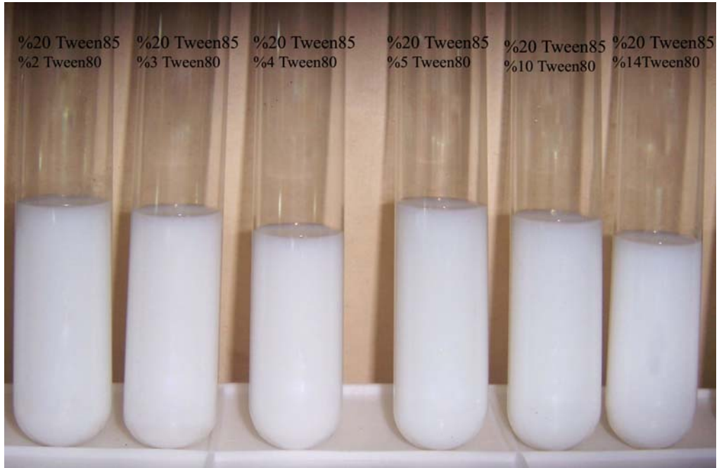
Şekil 30. Ham ayçiçeği yağı ve Tween 85-Tween 80 yüzey aktif madde karışımlarından elde edilen metal kesme sıvıları
