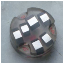
Şekil 6.3.1 . Borlanmış numunelerin soğuk kalıplama işleminden sonra aşındırılmış görüntüleri
