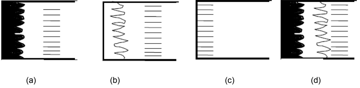
Şekil 4.1.2 Tek fazlı FeB tabakası, b) Tek fazlı Fe 2 B tabakası, c) Geçiş bölgesi, d) Çift fazlı FeB+Fe 2 B tabakası.
