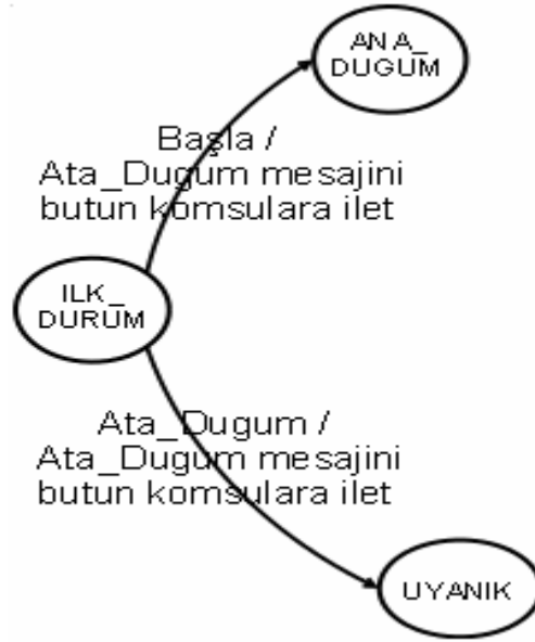
Şekil 3.2. DATKA İçin Kullanılan Sonlu Durum Makinesi
