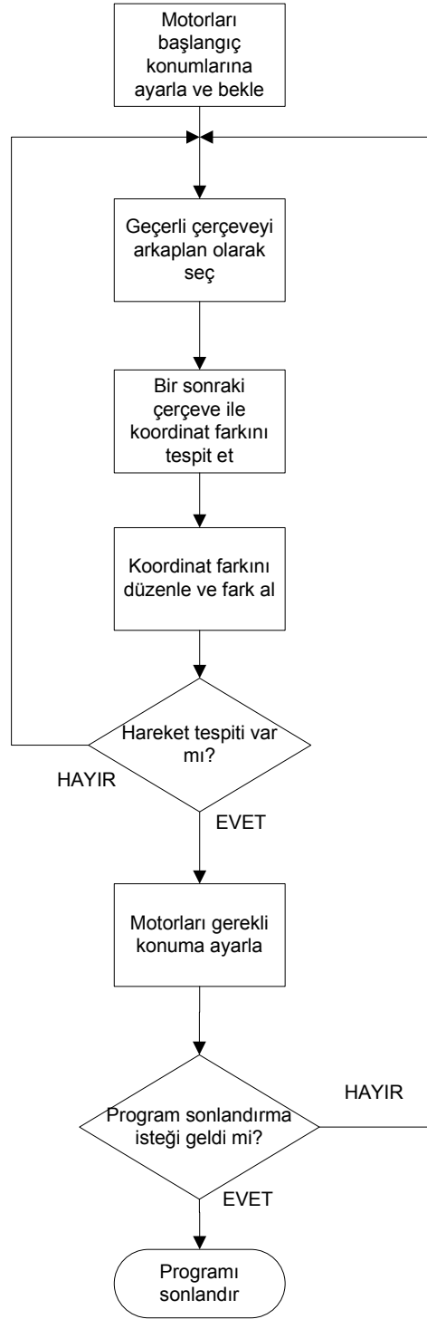
Şekil 4.6 Köşe tespitli çerçeve farkı yöntemine dayalı algoritma.
