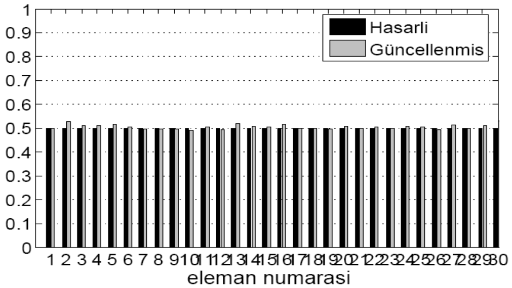
Şekil 5.9: Yayılı hasarlı kirişte orta hasar durumunda düzeltme katsayıları
