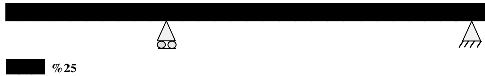
Şekil 5.2: Yayılı hasarlı kirişte hafif hasar durumu
