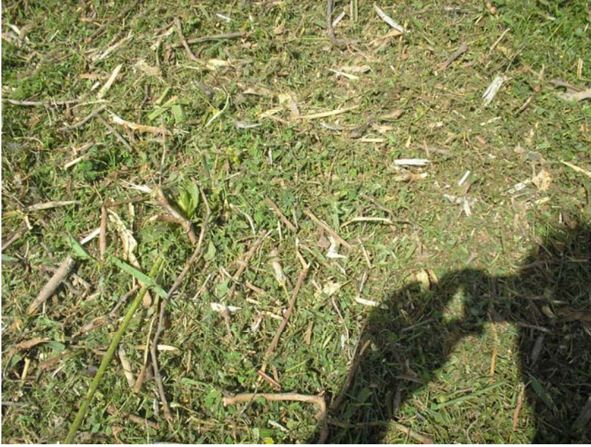
Şekil 5.14. Sap parçalama makinası prototip 1 tarafından parçalanmış bağ çubukları
