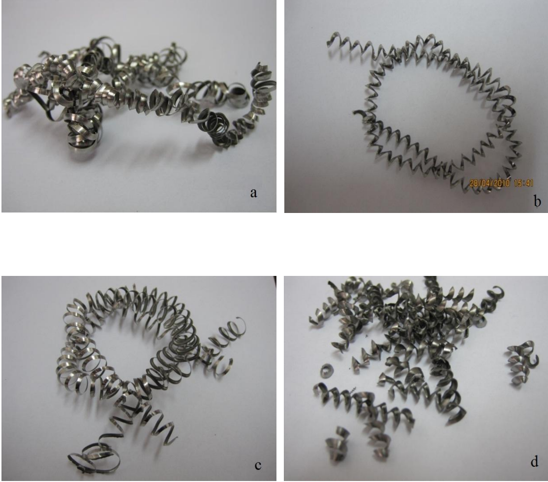
Resim 5.1 Farklı soğutma su basınçlarına bağlı olarak elde edilen talaş biçimleri a) P6 b) P100 c) P200 d) P300
