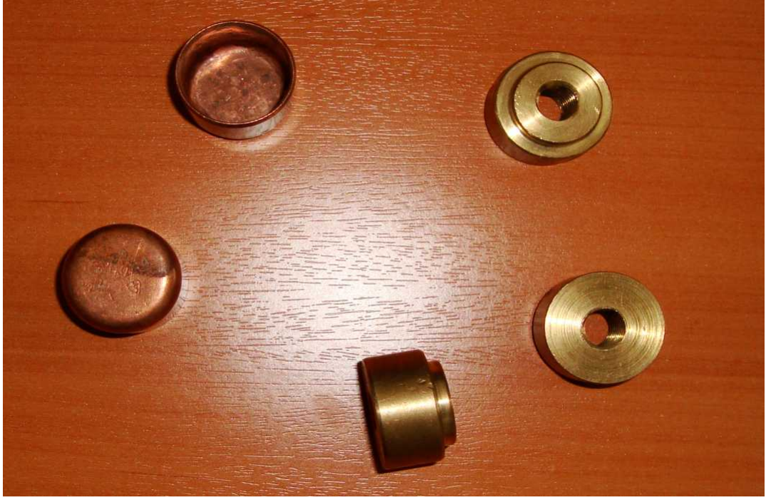
ekil 4.1. Isı borusunda kapak olarak kullanılan sarı pirinç malzeme ve bakır kapak
