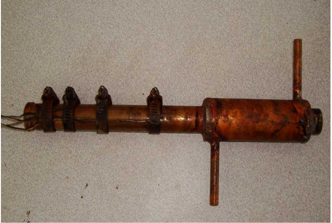
ekil 4.3. Termokupulların ısı borusuna kelepçeler yardımıyla yerle tirilmesinin gösterimi
