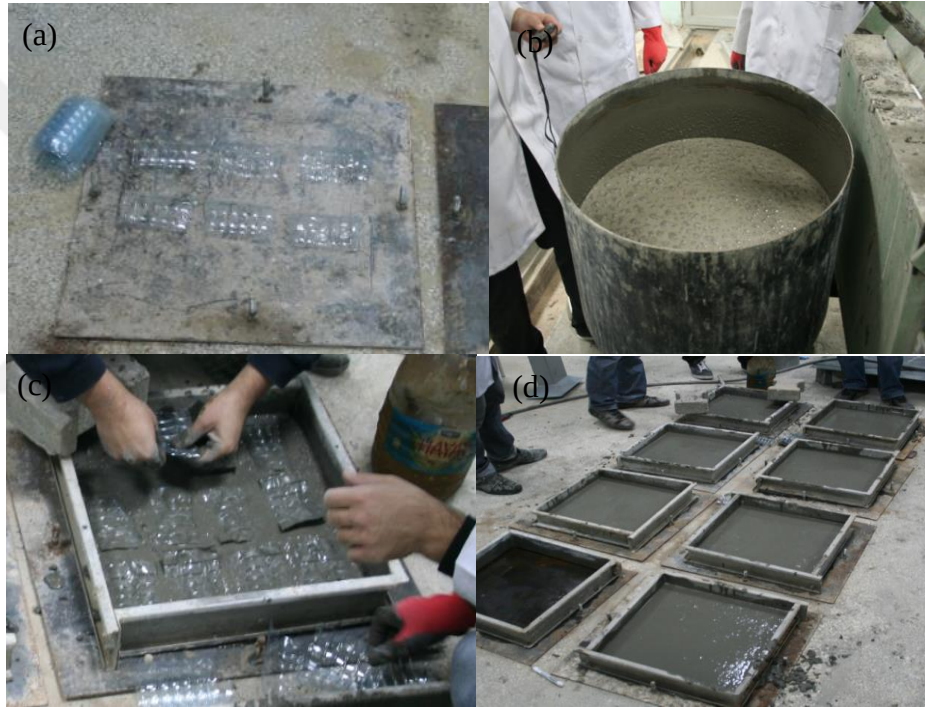
Şekil 3.12. a. Atık petlerin kesilmesi b. Malzemenin hazırlanması c. Atık petlerin yerleştirilmesi d. Numenelerin son hali
