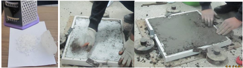
Şekil 3.11. Parafin katkılı numunelerin oluşturulması
