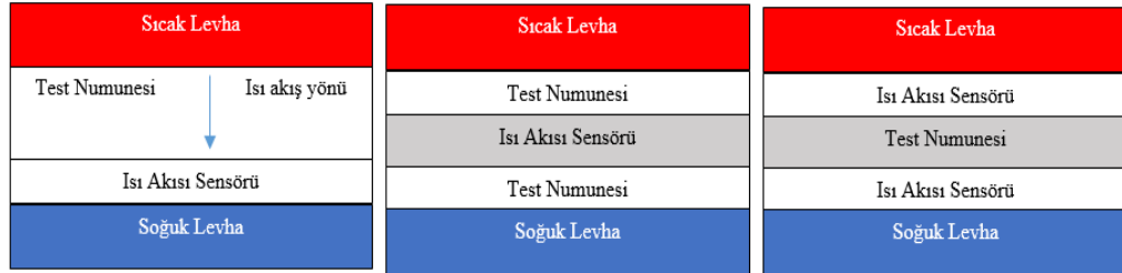
Şekil 2.2. a. Isı akısı ölçme aparatının mekanik bileşenleri genel görünümü b. Bir ısı akısı sensörlü ve iki numuneli aparat c. İki ısı akısı sensörlü ve bir test numuneli aparat
