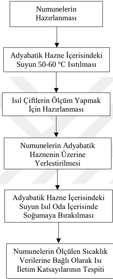
Şekil 4.3. Adyabatik hazne yönteminin akış şeması
