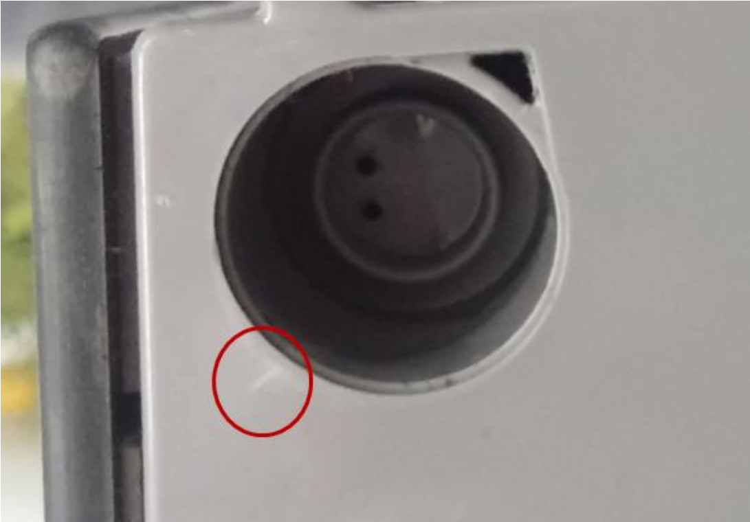
Şekil 6.3 : Öneri 4 - 1 mm kalınlığında 301 paslanmaz çelik ile test.
