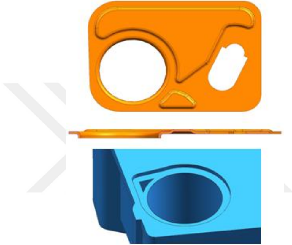
Şekil 4.3 : Kapı alt destek sacı – Öneri 2.
