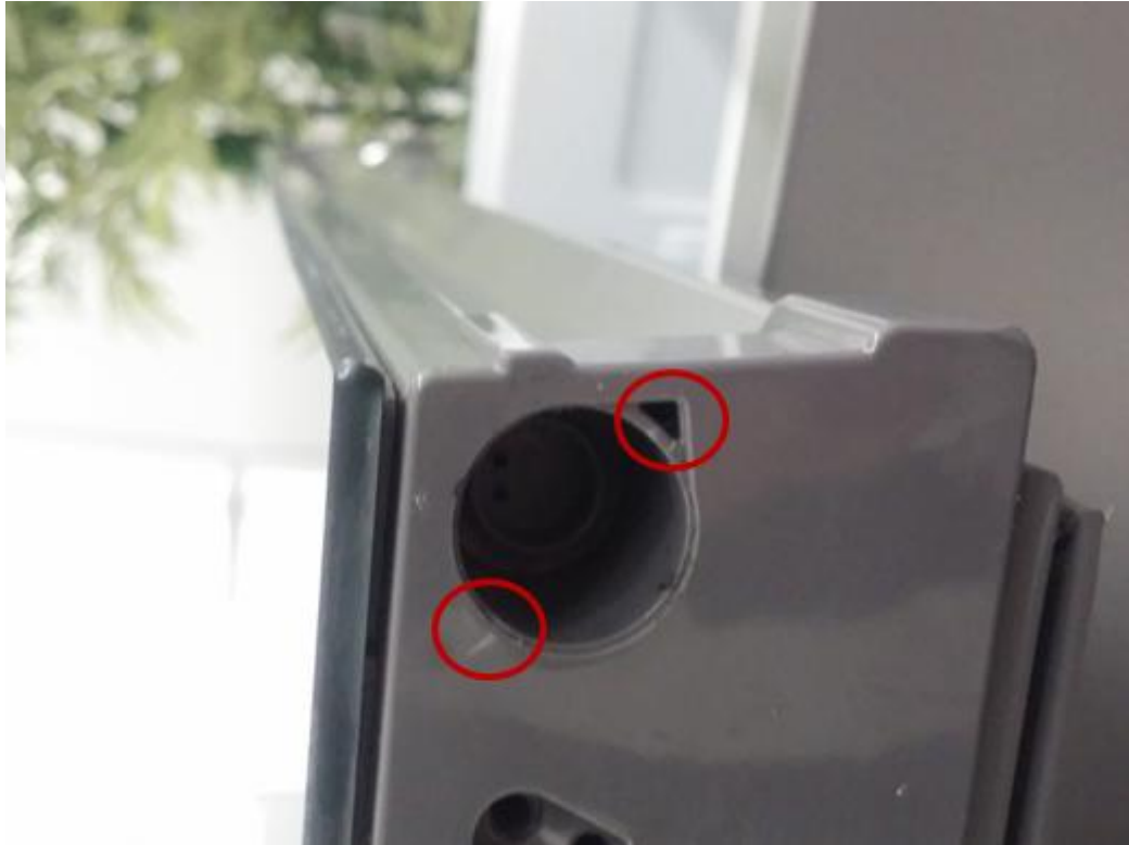
Şekil 6.2 : Öneri 3 - 0,5 mm kalınlığında 301 paslanmaz çelik ile test.
