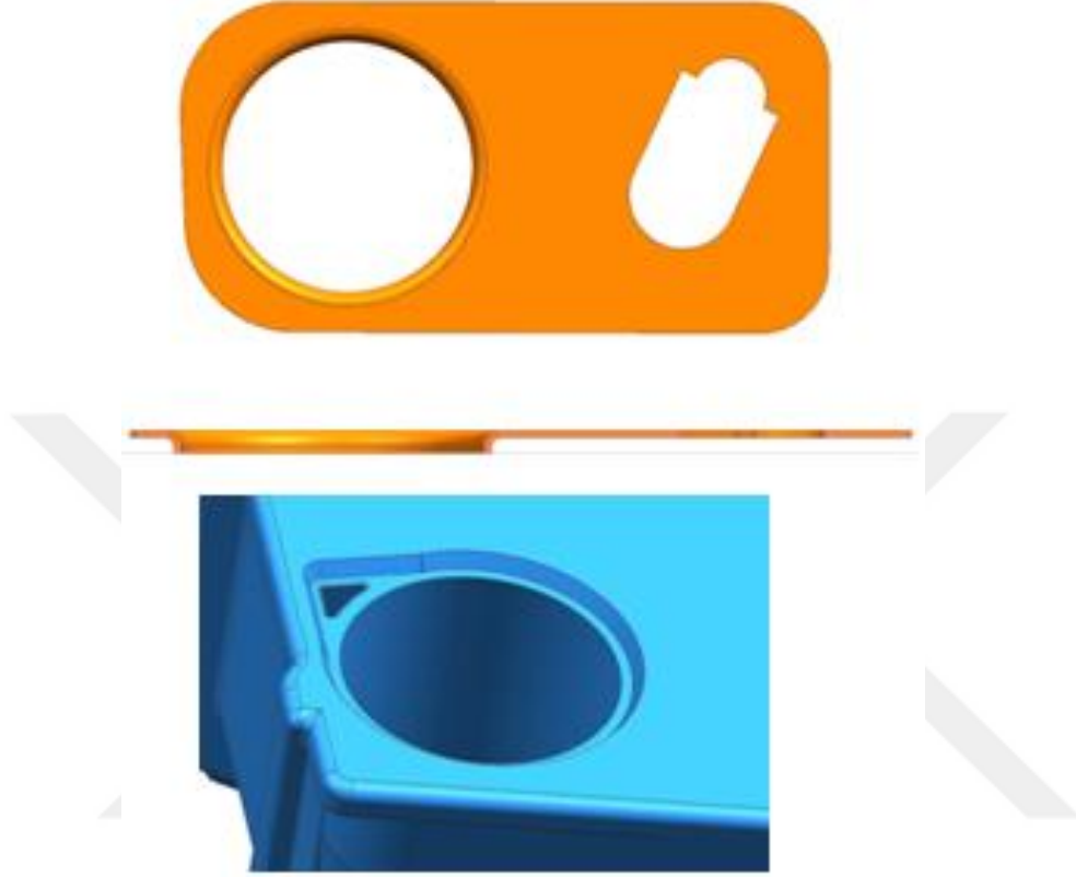
Şekil 4.2 : Kapı alt destek sacı – Öneri 1.
