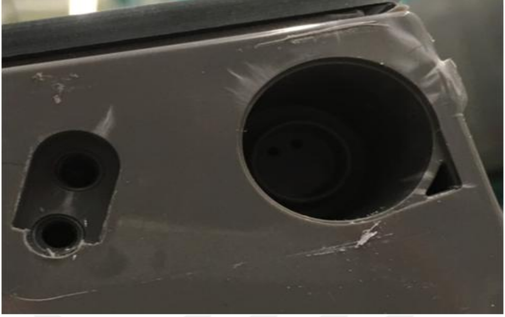
Şekil 2.3 : Kapı alt kapama plastik parçasında gözlemlenen hasar.
