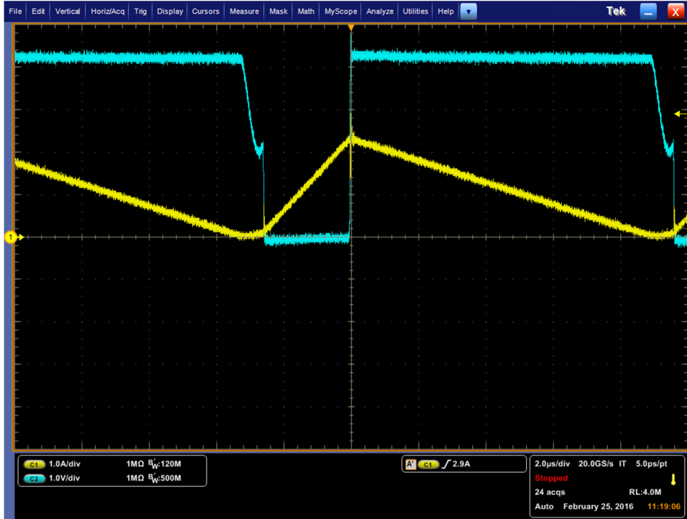
Şekil 3.6: Endüktans akımı (sarı) ve MOSFET üzerindeki (drain) gerilim (mavi) dalga şekilleri (ölçekler: 1A/div, 100V/div, 2µs/div)
