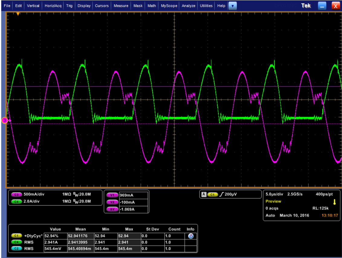
Şekil 3.38: Primerdeki Rezonans Akımı (Pembe) ve Sekonderdeki Senkron Doğrultma Akımı (Yeşil)
