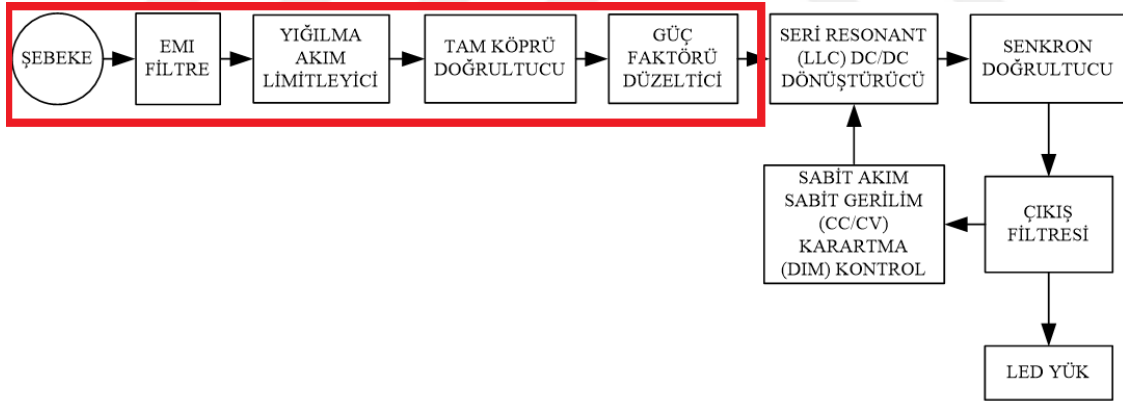
Şekil 2.1: Sabit Akım/Sabit Gerilim Kontrollü LED Sürücü Devresinin Giriş ve PFC Blok Diyagramı
