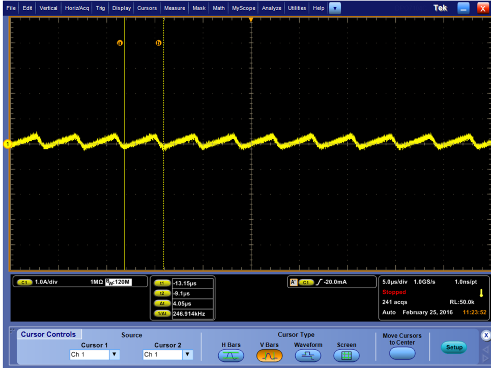
Şekil 3.3: Endüktans akımının minimum değerindeki dalga şekli (ölçekler: 1 A/div, 5 μs/div)
