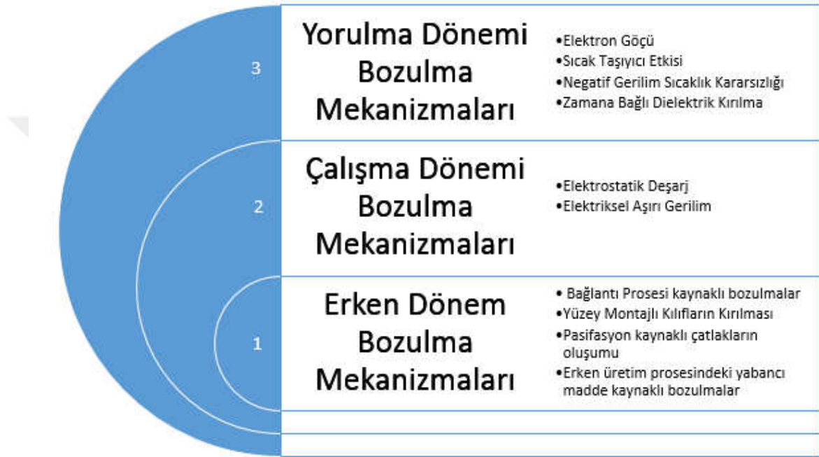
Şekil 2.15: Yarıiletkenlerin zamana bağlı bozulma mekanizmaları.
