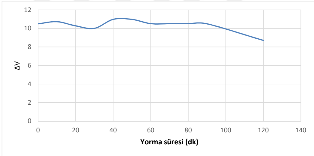
Şekil 4.39: AB Sınıfı güç kuvvetlendirici için çıkışın doğrusal aralığının yormaya bağlı değişimi.
