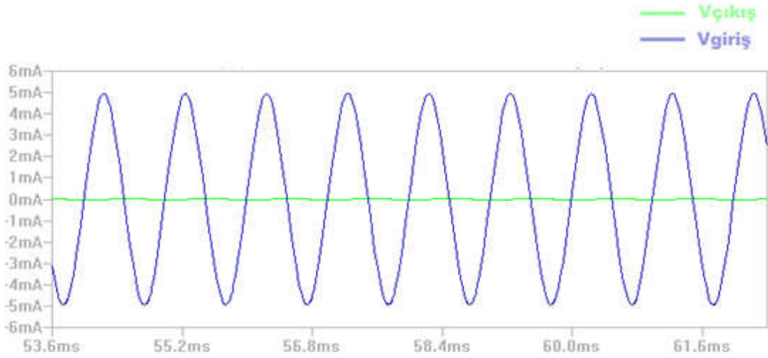
Şekil 4.33: AB Sınıfı güç kuvvetlendirici için giriş ve çıkış akım işaretleri grafiđi.
