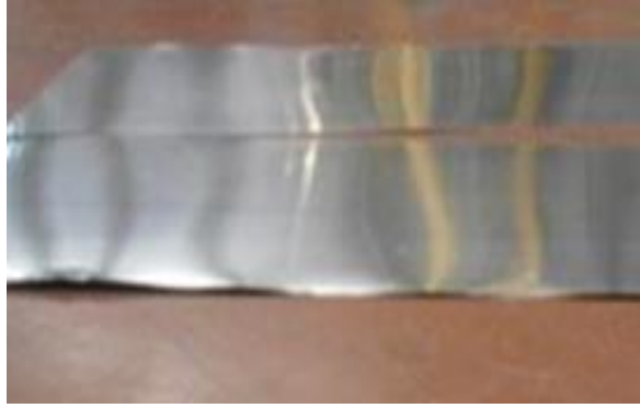
Şekil 5.10. Kenar dalgası hatası.
