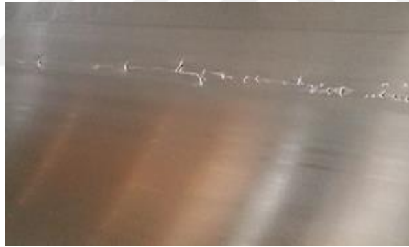
Şekil 5.3. Gaz boşluğu hatası.
