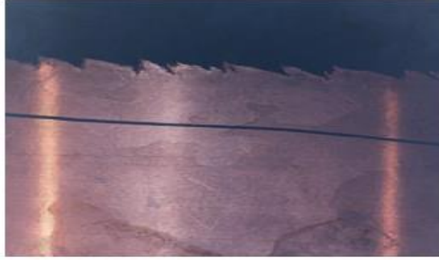
Şekil 5.4. Kenar çatlağı hatası.
