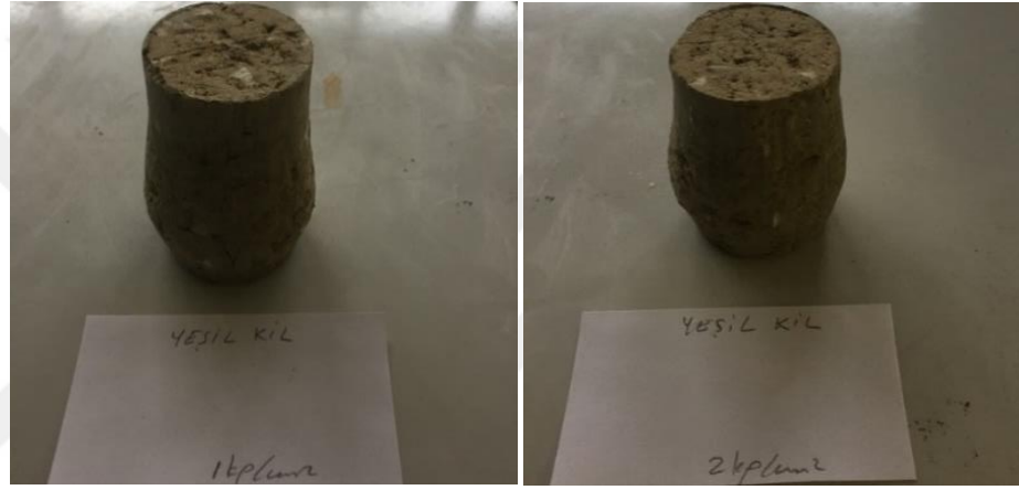
Şekil 5.14. Numune B'nin 1 ve 2 kg/cm 2 yüklemeli üç eksenli basınç deneyi
