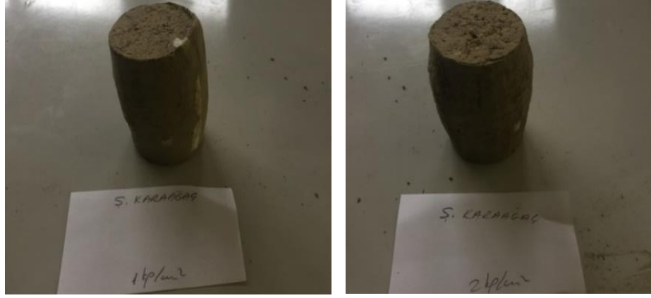
Şekil 5.13. Numune A'nın 1 ve 2 kg/cm 2 yüklemeli üç eksenli basınç deneyi
