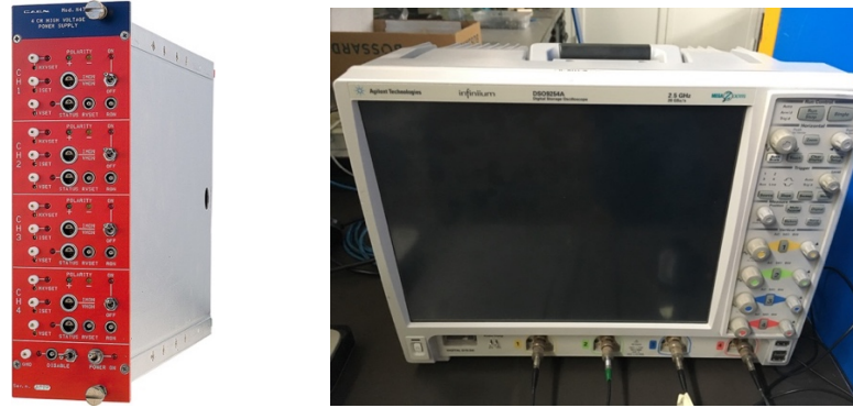
Şekil 3.8: Solda CAEN N472 HV ünitesi [23]. Sağda Agilent Technologies DSO9254A osiloskop.
