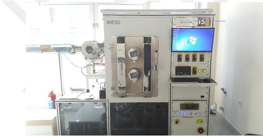
Şekil 3.2. Üretimlerin yapıldığı VAKSİS Midas 4T1M PVD sistemi
