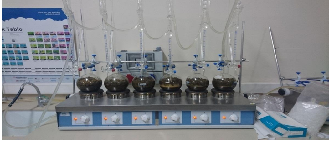
Şekil 3.5. Nane klon ve çeşitlerinde Clevenger cihazı ile uçucu yağ eldesi
