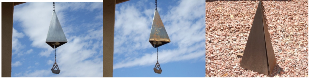
Şekil 3. 3 WS nin başlangıç görünümü ve hidrojen peroksit-tuz-sirke çözeltisi uygulandıktan sonraki oksitlenmiş görünümü [53]
