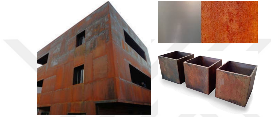
Şekil 3. 2 WS Levha elemanlarda zaman içinde patina yüzey oluşumu [50,51,52]
