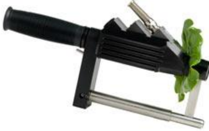
Şekil 3.9 Kontak prop tekniğiyle spektrum ölçümü
