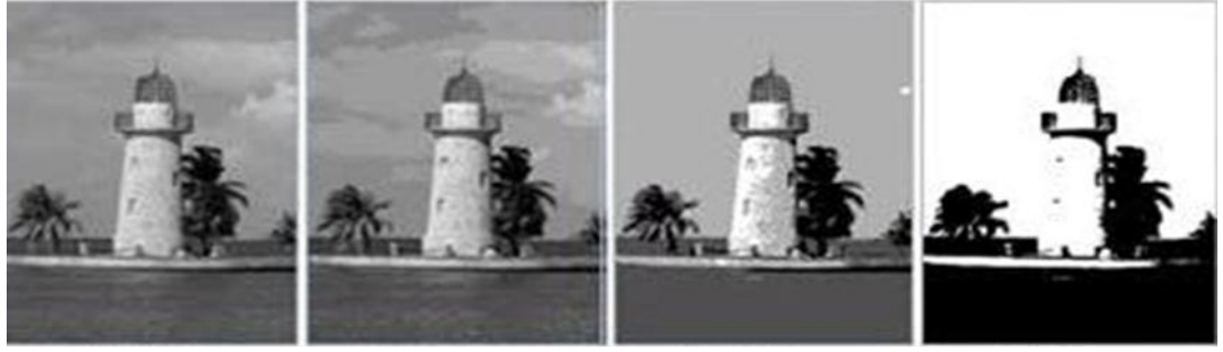
Şekil 1.14 Aynı sahnenin farklı radyometrik çözünürlüklü görüntüleri
