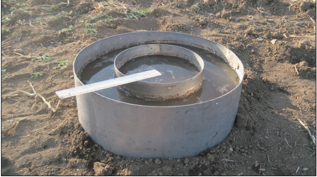
řekil 3.6. Deėiřken seviyeli ift silindirli infiltrometre ile infiltrasyon hızının llmesi
