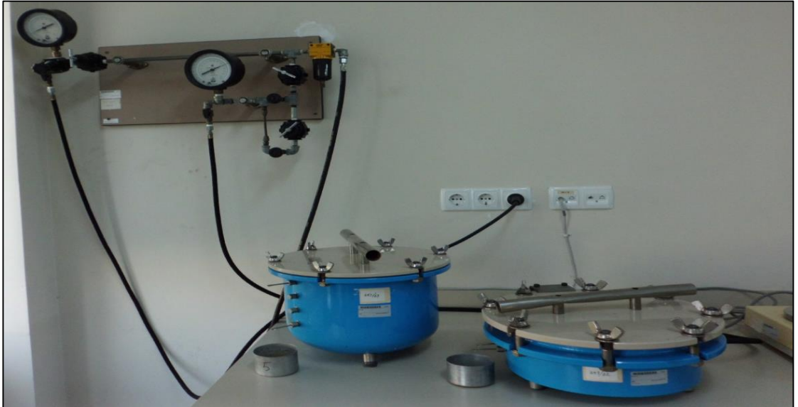
Şekil 3.5. Tarla kapasitesi ve solma noktası değerlerinin belirlendiği basınçlı tabla cihazı
