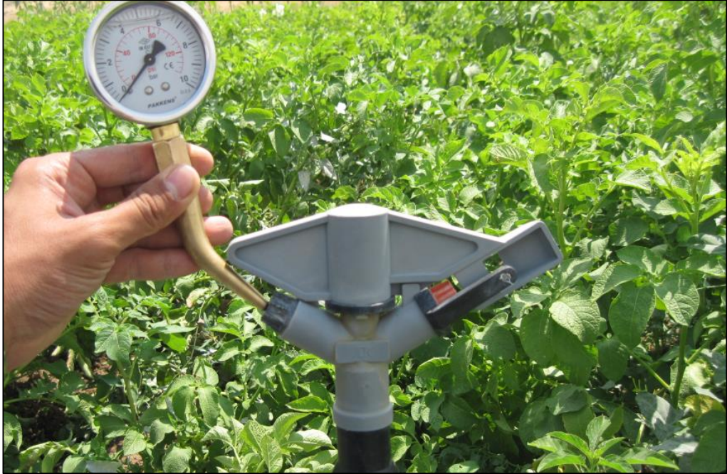
Şekil 3.8. Yağmurlama başlıklarının ölçümünde kullanılan pitot tüplü manometre
