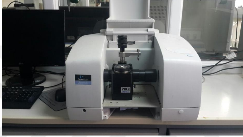
Şekil 2.1: İnfrared (IR) ölçümleri,Perkin-Elmer model spektrum 65 cihazı.
