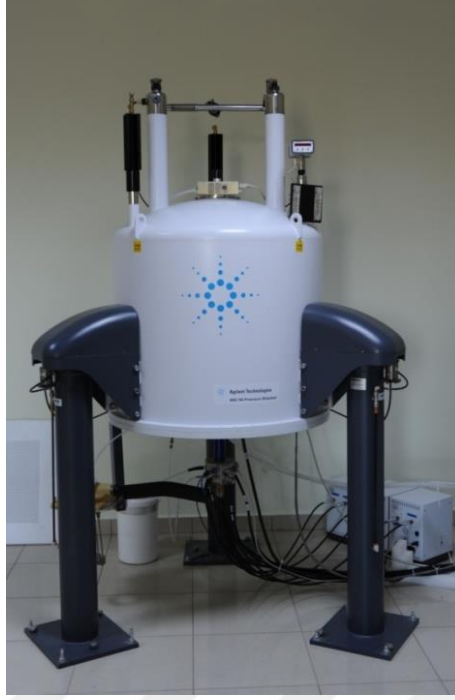
Şekil 2.2: Agilent technologies marka 400 MHz'lik sıvı NMR spektroskopisi.
