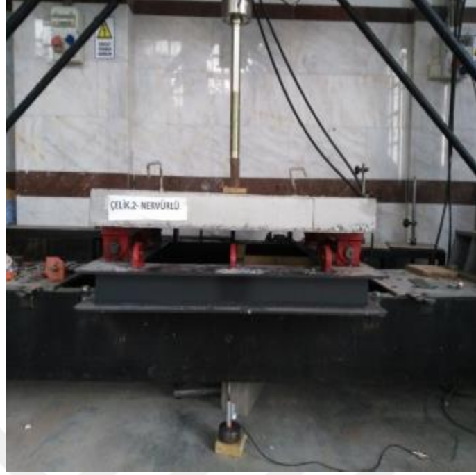
Şekil 4.37. Çelik donatılı döşeme kırılma öncesi
