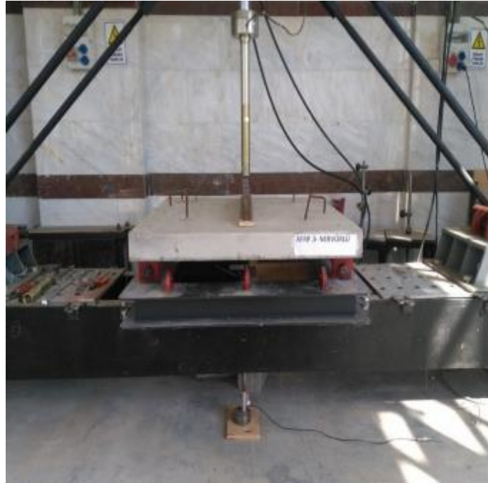
Şekil 4.42. AFRPN donatılı döşeme kırılma öncesi
