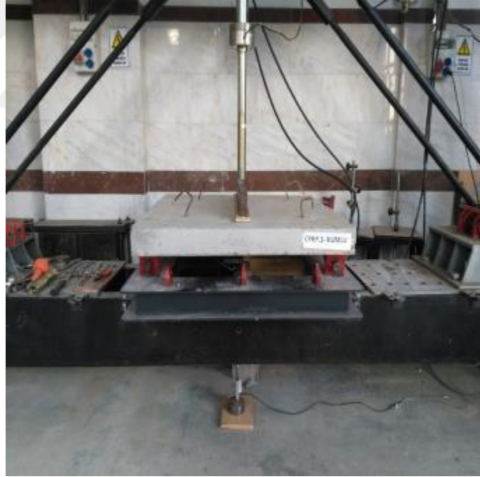
Şekil 4.40. CFRPK donatılı döşeme kırılma öncesi
