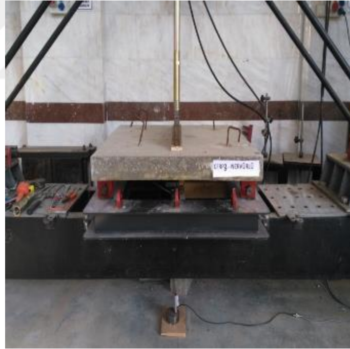
Şekil 4.44. CFRPN donatılı döşeme kırılma öncesi
