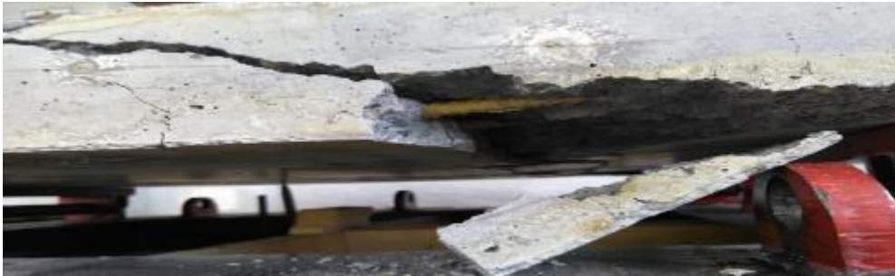
Şekil 4.62. AFRPN donatılı döşeme kırılma detayı
