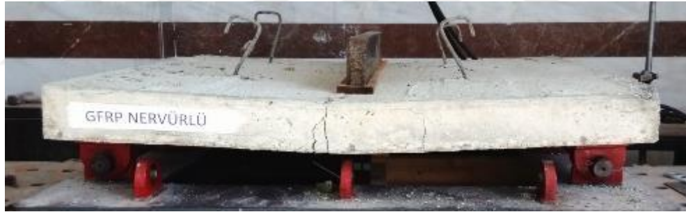
Şekil 4.82. GFRPN donatılı döşeme kırılma sonrası
