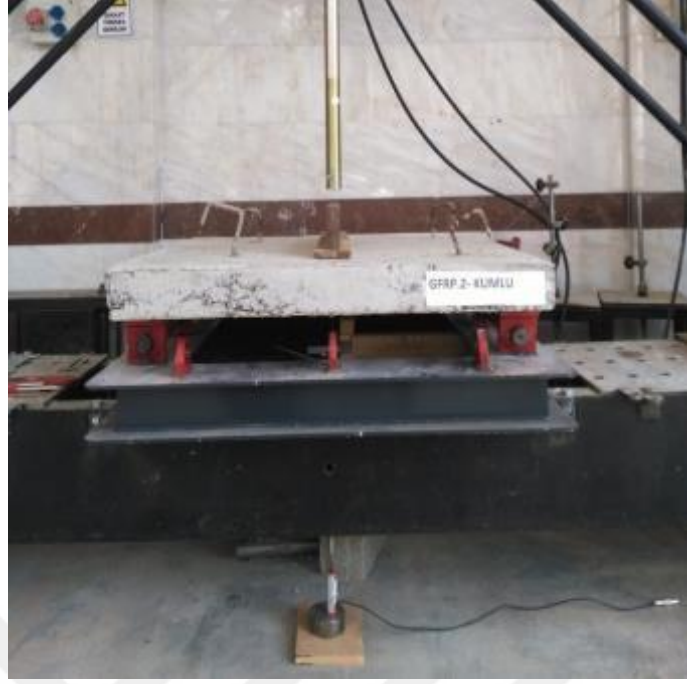
Şekil 4.41. GFRPK donatılı döşeme kırılma öncesi
