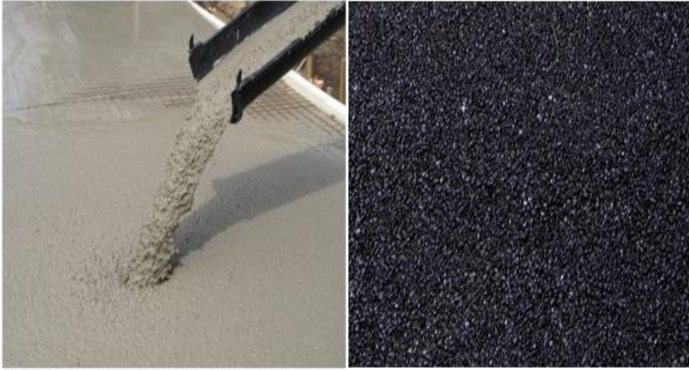
Şekil 2.1. Tanecikli kompozit olan beton ve asfalt [5, 6].
