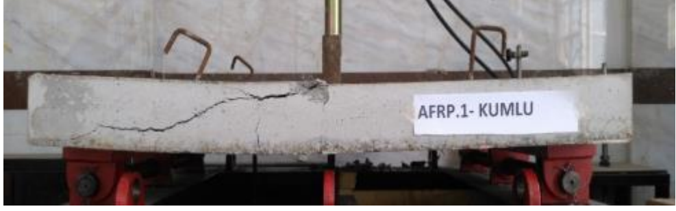
Şekil 4.59. AFRPK donatılı döşeme kırılma sonrası
