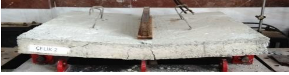
Şekil 4.52. Çelik donatılı döşeme kırılma sonrası
