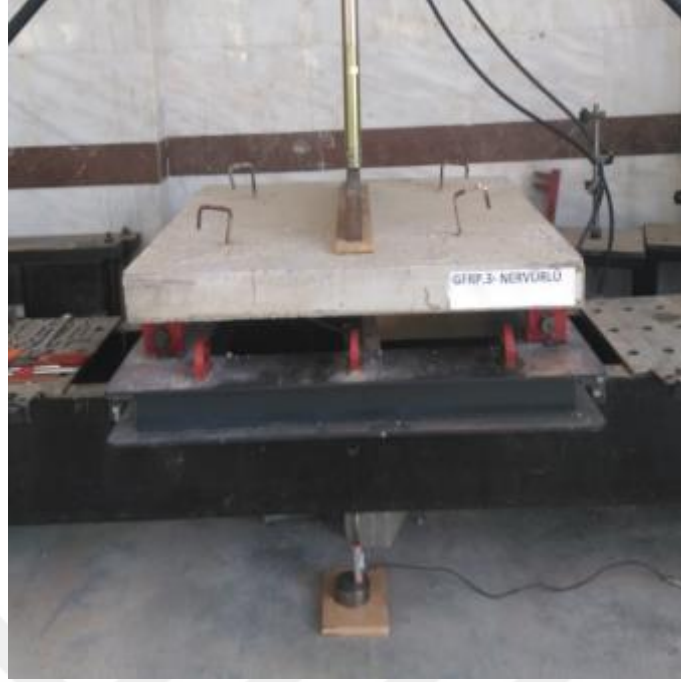
Şekil 4.45. GFRPN donatılı döşeme kırılma öncesi
