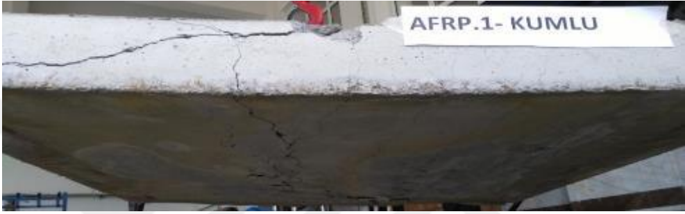
Şekil 4.60. AFRPK donatılı döşeme kırılma detayı
