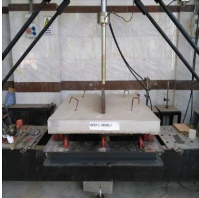
Şekil 4.38. AFRPK donatılı döşeme kırılma öncesi
