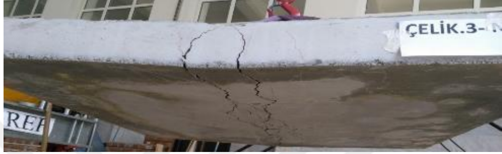
Şekil 4.53. Çelik donatılı döşeme kırılma detayı
