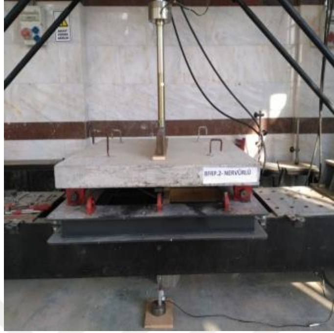
Şekil 4.43. BFRPN donatılı döşeme kırılma öncesi
