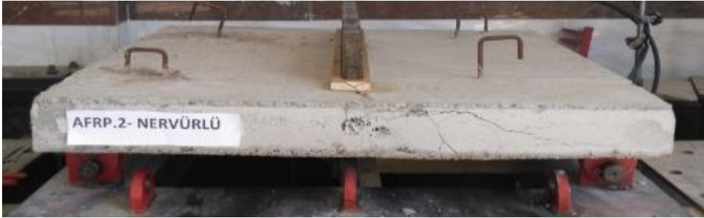
Şekil 4.61. AFRPN donatılı döşeme kırılma sonrası
