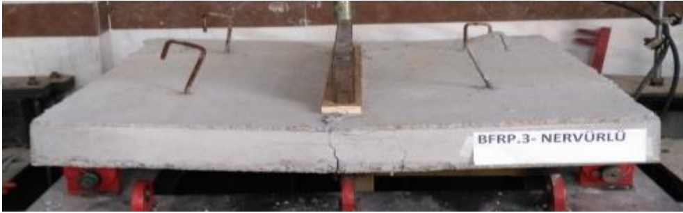
Şekil 4.70. BFRPN donatılı döşeme kırılma sonrası
