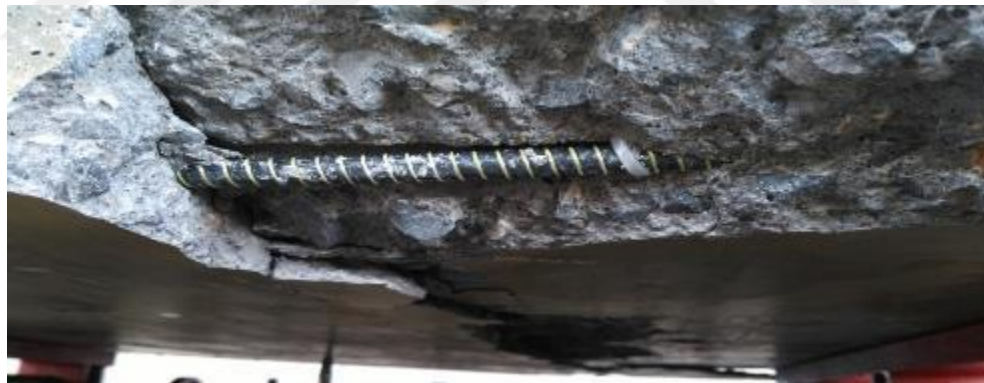
Şekil 4.74. CFRPN donatılı döşeme kırılma detayı
