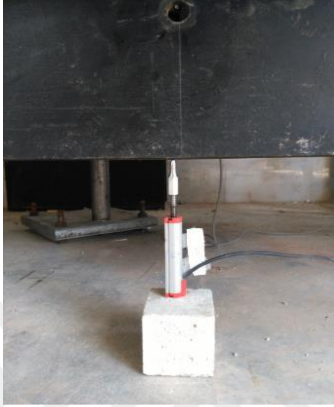
Şekil 4.34. Çerçeve sisteme yerleştirilmiş potansiyometre
