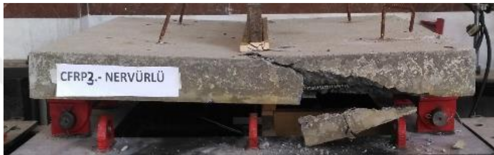
Şekil 4.73. CFRPN donatılı döşeme kırılma sonrası
