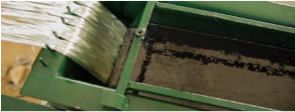
Şekil 3.3. FRP donatı çubukların üretiminde reçine işlemi
