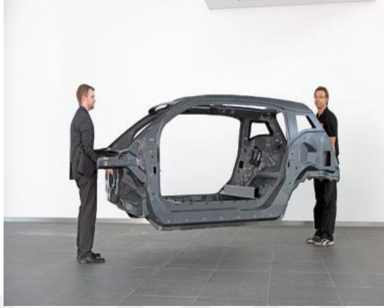
Şekil 2.4. Hafif ve dayanımı yüksek karbon elyafı ile üretilmiş yolcu kabini [10].
