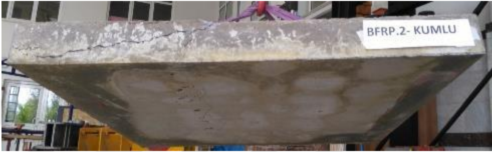
Şekil 4.69. BFRPK donatılı döşeme kırılma detayı
