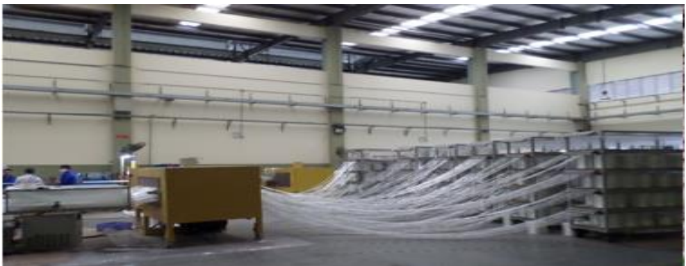
Şekil 3.4. FRP donatı çubukları üretim işlemi
