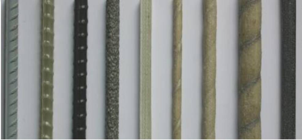
Şekil 3.9. Farklı Yüzey özelliklerine sahip FRP donatılar [24].
