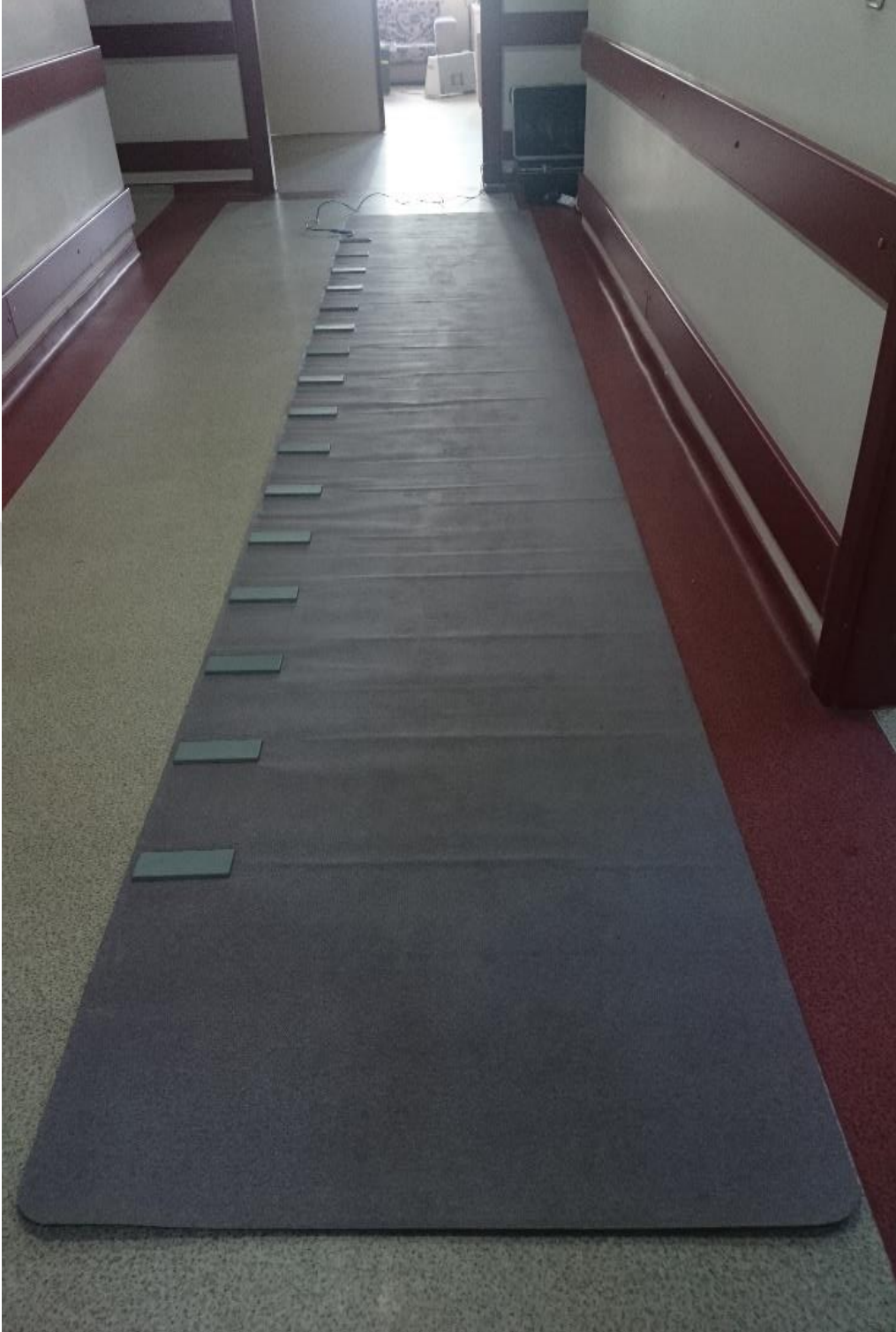
Şekil 3.2. GAITRite Bilgisayarlı Analiz Sistemi
