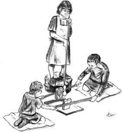
Resim 26. Kalıba Üfleme Tekniği, Çakmaklı 2007, s. 45, res. 10
