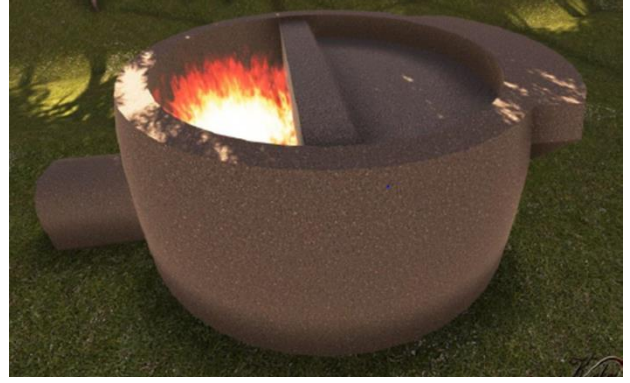
Resim 7-8. Potalı Cam Fırını Kesit Restitüsyonu ve Tanklı Cam Fırını Üstten Kesit Restitüsyonu, Eker 2014, s. 77, 78
