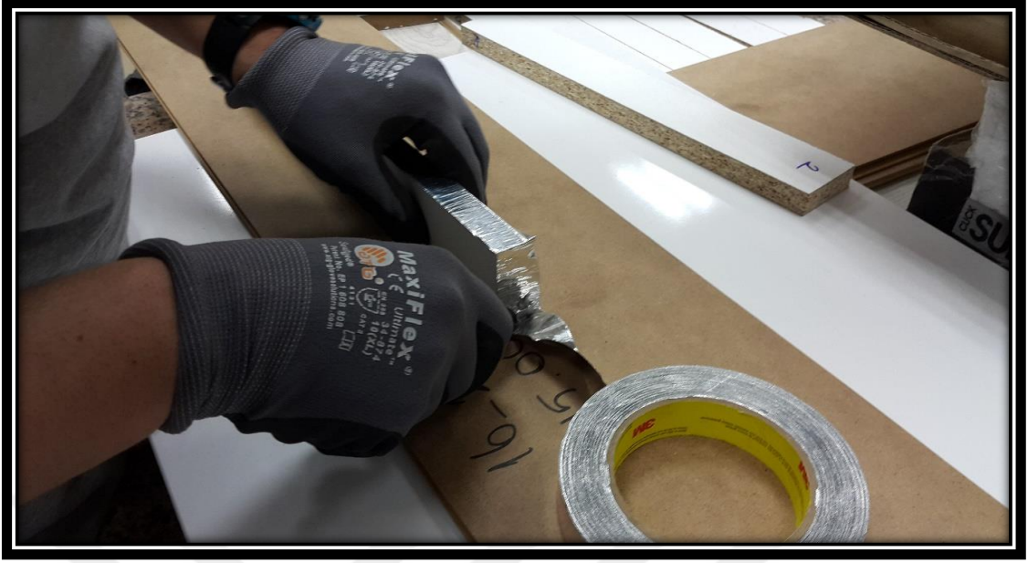
Şekil 3.13: Formaldehit emisyonu için hazırlanan örneklerin kenarlarının kaplanması.
