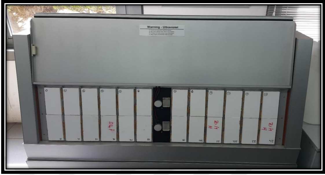
Şekil 3.27: Örneklerin QUV cihazına yerleştirilmesi.
