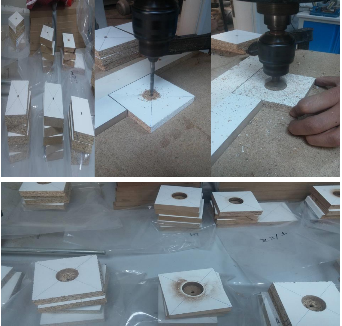
Şekil 3.17: Aşınma direnci için numunelerin hazırlama işlemi.
