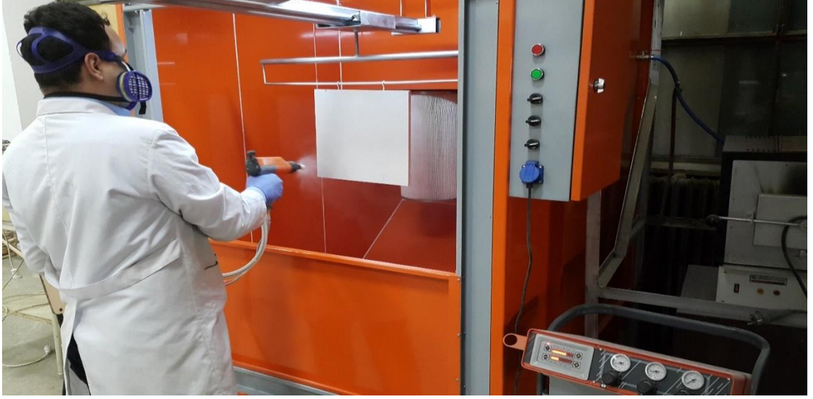
Şekil 3.2: Boyama kabini içerisinde 25 \times 35 cm ebatlarında örnekler toz boya işleminin gerçekleştirilmesi.
