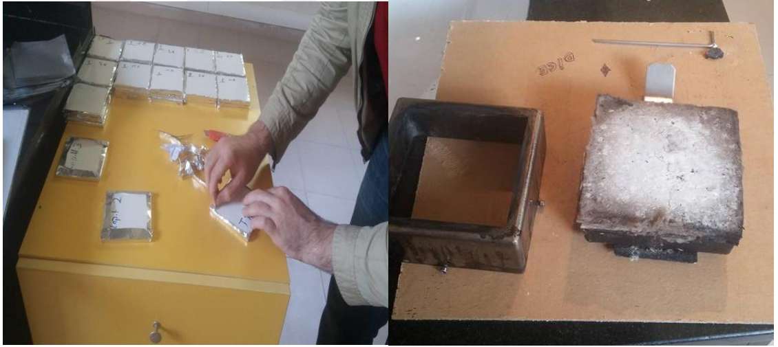
Şekil 3.9: Yanma deneyi örneklerinin alüminyum folyo ile kaplanması.
