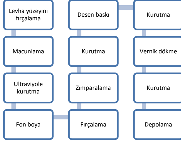
Şekil 2.6: Yongalevha üzerine desen baskı işleminin iş akışı.
