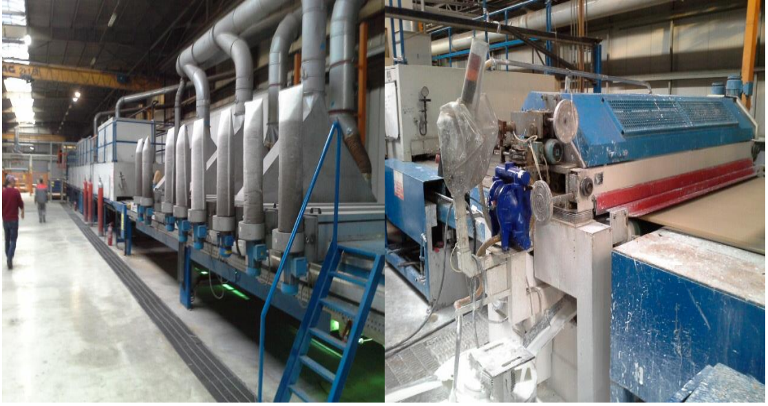
Şekil 3.6: Levha yüzeylerine UV kurumalı su bazlı boya işleminin gerçekleştirildiği hat.
