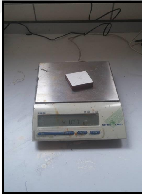
Şekil 3.12: Deney örneklerinin dijital terazi ile ağırlıklarının ölçülmesi.
