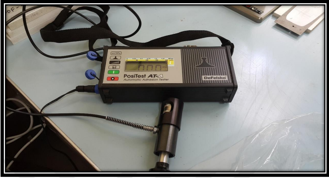
Şekil 3.20: PosiTest AT-A otomatik yapışma test cihazı.
