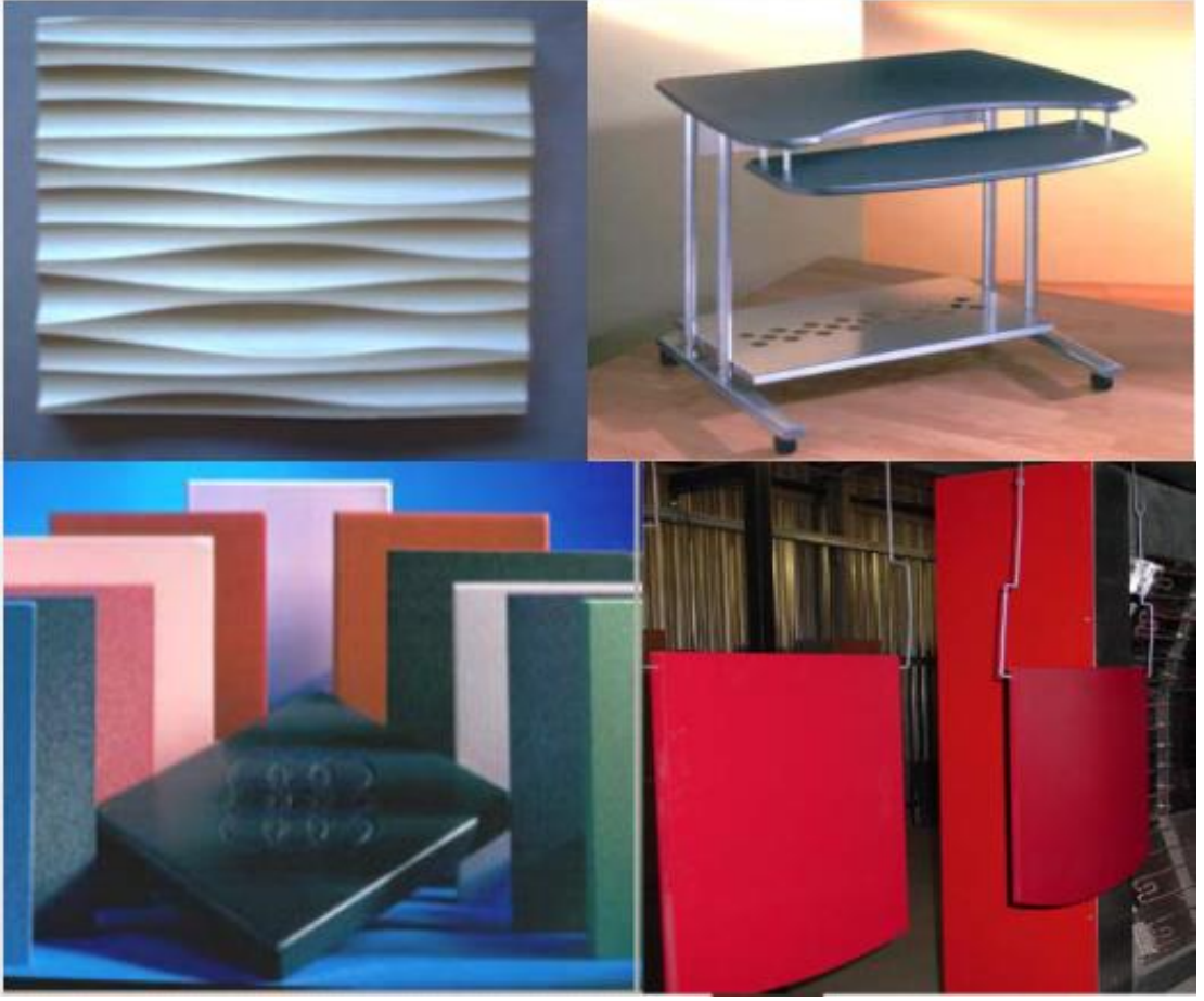
Şekil 2.58: Elektrostatik toz boya uygulanmış MDF örnekleri [56].
