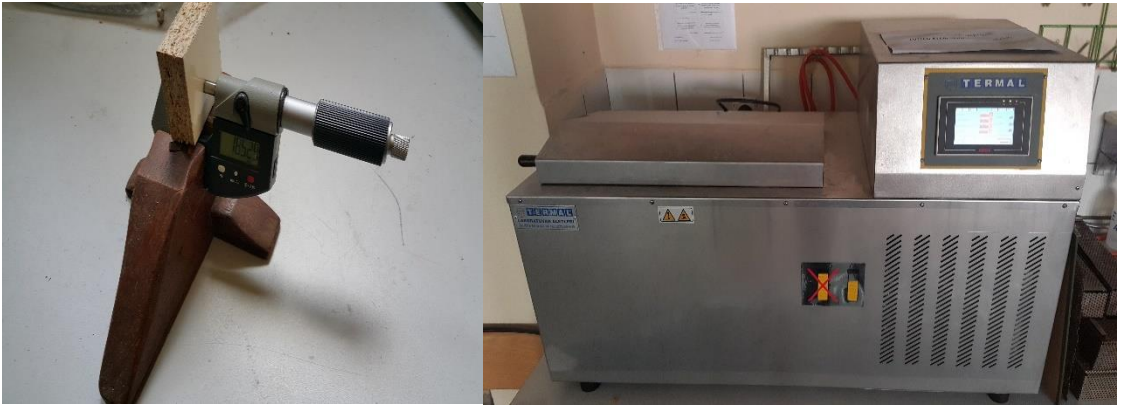
Şekil 3.11: Deney örneklerinin kalınlığının ölçülmesi ve termostatlı su banyosu.
