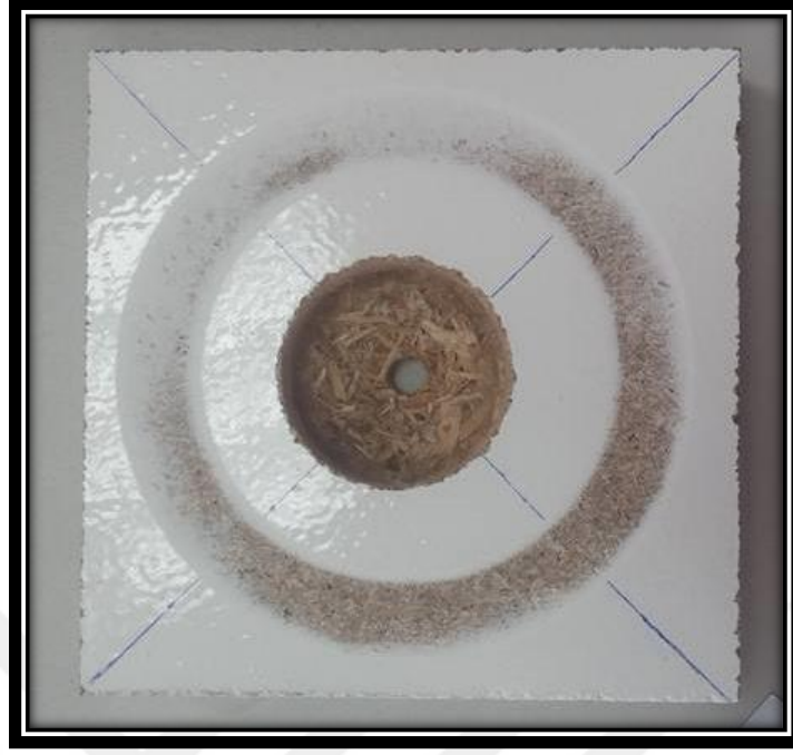
Şekil 3.19: Aşınma deneyi tamamlanmış bir örneğin yüzeyi.
