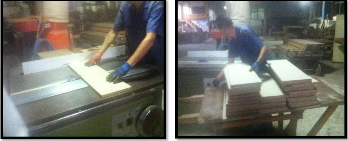
Şekil 3.1: Levhaların daire testerede ebatlama işlemi.
