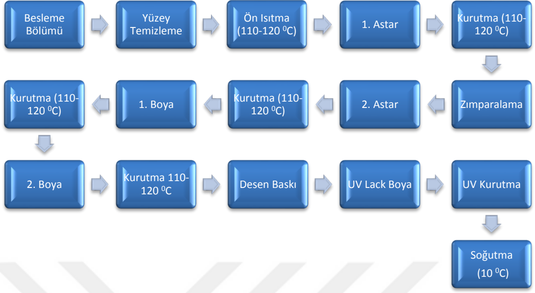
Şekil 3.7: Levha yüzeylerine su bazlı boya uygulama işlem basamakları.
