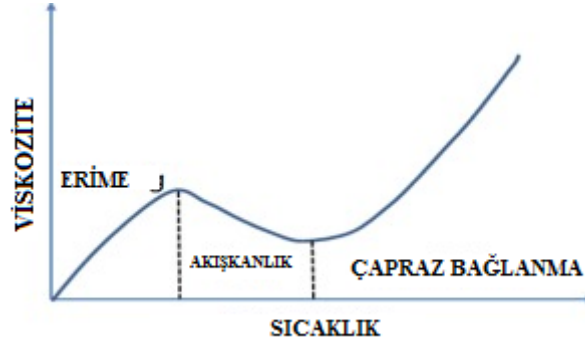
Şekil 2.52: Kürlenme esnasında film oluşum davranışı [102].
