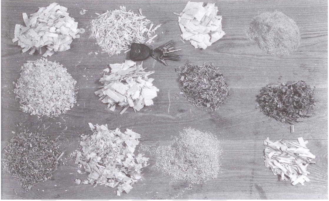
Şekil 2.1: Yongalevha üretiminde kullanılan çeşitli tip yongalar [9].
