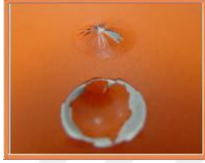
Şekil 2.41: Düşük mekanik dayanım gösteren toz boya uygulaması [37].
