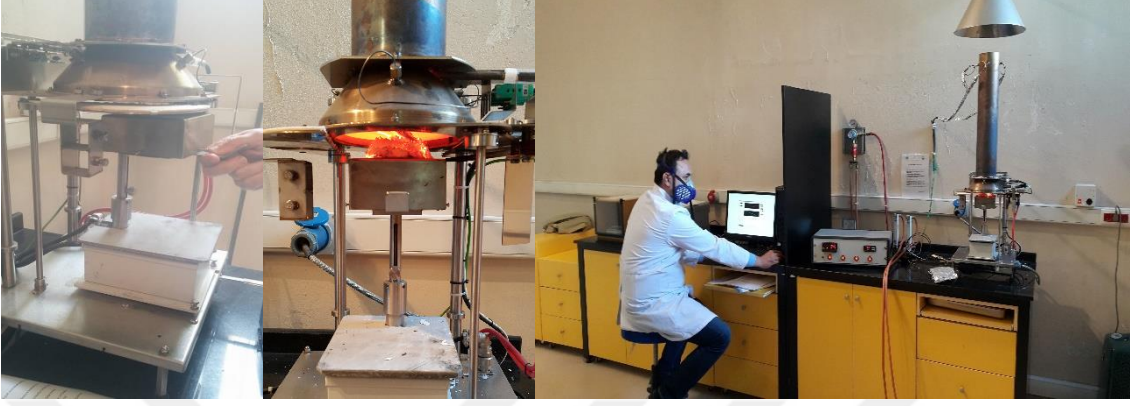
Şekil 3.10: Levhaların yanma deneyinin yapılışı.
