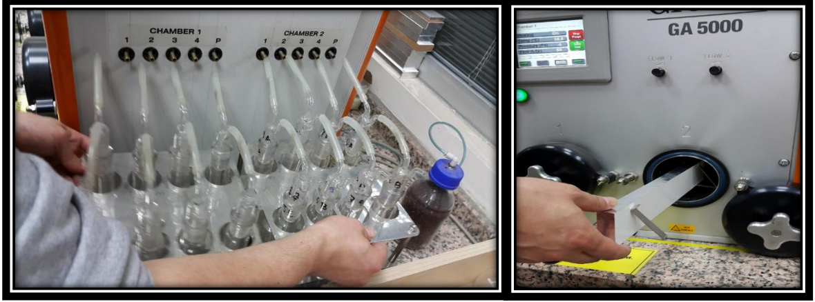
Şekil 3.14: İçerisinde saf su bulunan gaz yıkama şişeleri ve numunelerin cihaza yerleştirilmesi.
