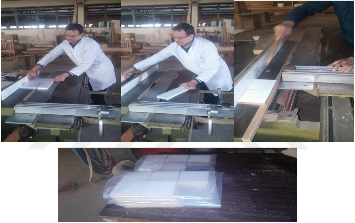
Şekil 3.5: Boyanmış örneklerin test standartlarına göre ebatlandırılması.
