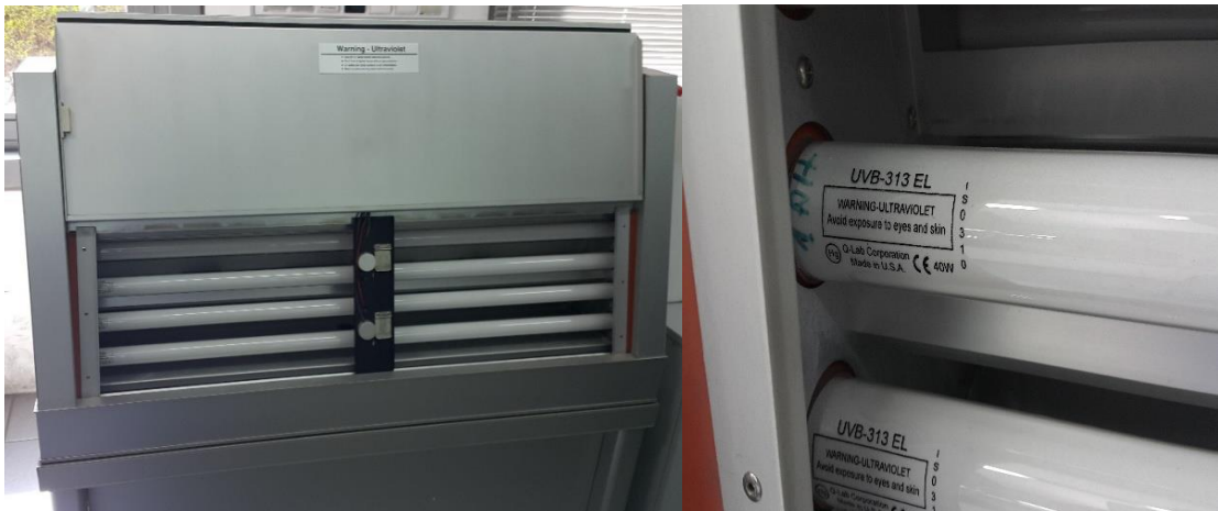
Şekil 3.28: Cihaza yerleştirilmiş UVB – 313 EL tipi lamba.
