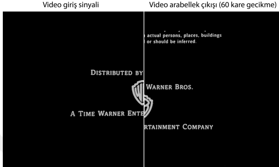
Şekil 5.2 Full-HD 1080p 60 Hz video girişi için Stratix IV GX kart üzerinde 60 kare büyüklüğünde arabellek gerçekleştirilmesi
