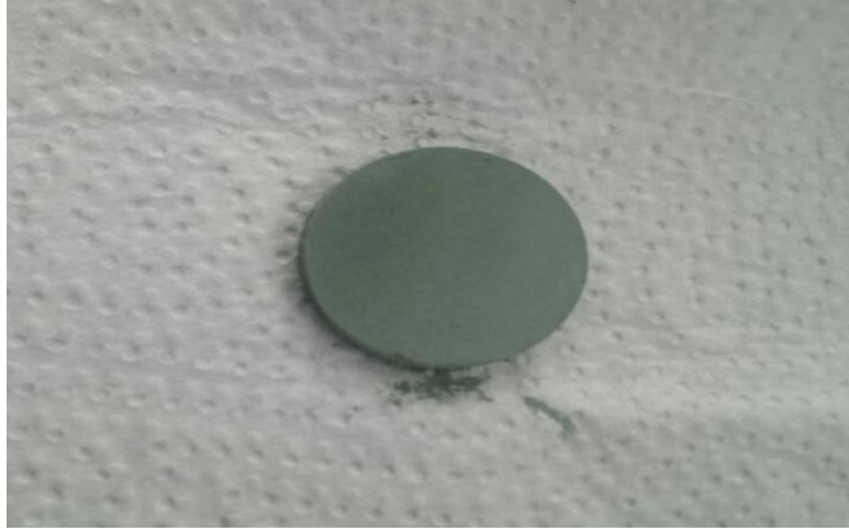
Şekil 3.5. Şekillendirilerek pellet haline getirilen Cr 2 O 3 katkılı cam tozu
