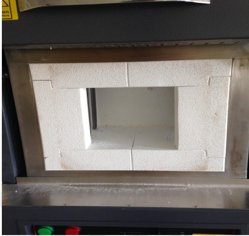
Şekil 3.6. Ergitmede kullanılan yüksek sıcaklık kül fırınının iç görünümü
