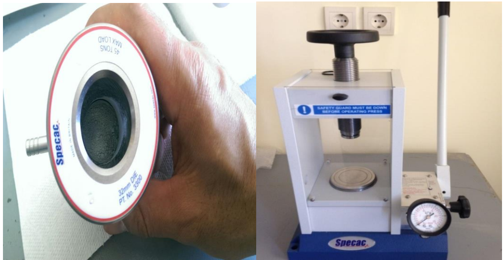
Şekil 3.4. Tozların konulduğu metal kalıp ve manuel hidrolik pres
