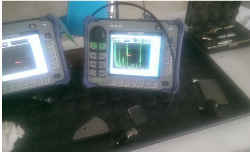
Şekil 3.12. Ultrasonik ses hızı test cihazı (Osiloskop)
