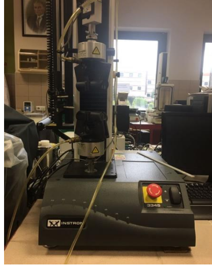
Şekil 3.7. Instron marka çekme cihazının görünümü
