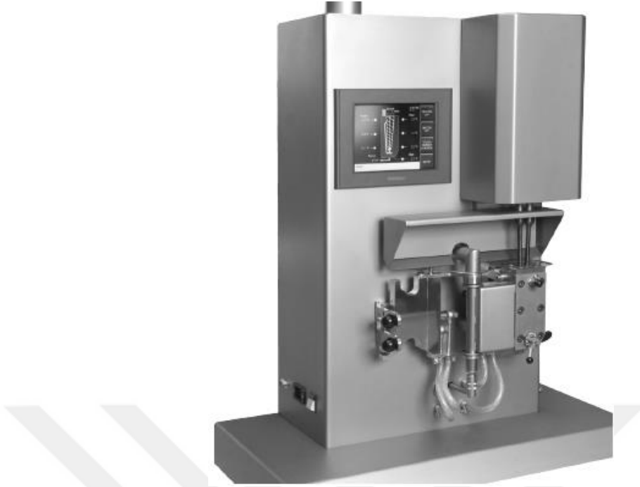
Şekil 3.2. Tez çalışmasında kullanılan mikro harmanlayıcı cihazı
