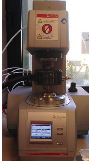
Şekil 3.8. Anton Paar marka reometre cihazının görünümü
