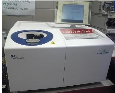
Şekil 3.9. Mettler Toledo DSC1 Star System marka DSC cihazının genel görünümü
