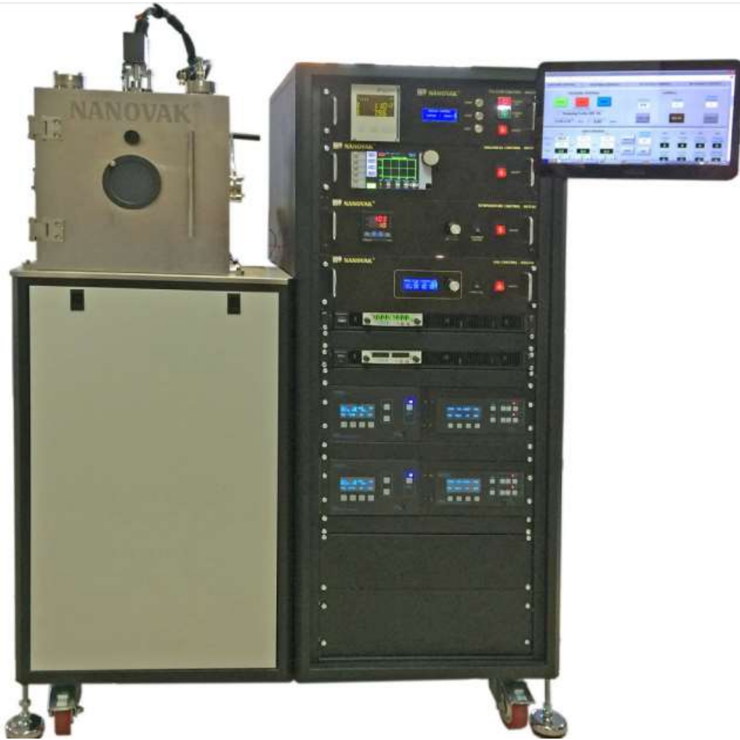
Şekil 3.14. Smart Laboratuvar bünyesinde bulunan Nanovak marka magnetron saçtırma cihazı
