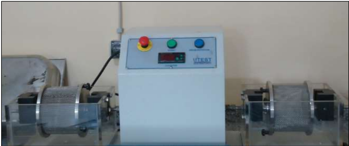
Şekil 4.21. Suda dağılmaya karşı duraylılık indeksi deney aleti.
