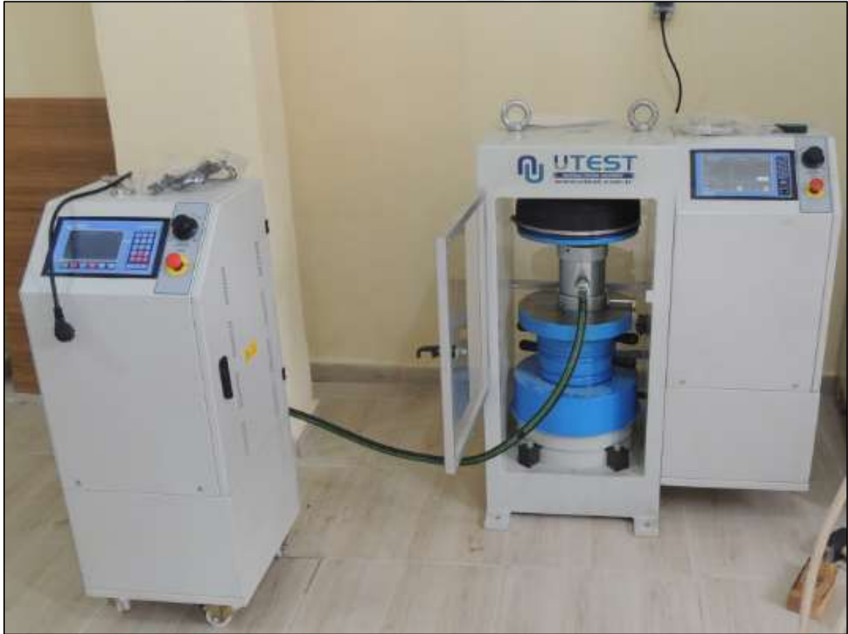
Şekil 4.20. Üç eksenli sıkıştırma deney aleti.
