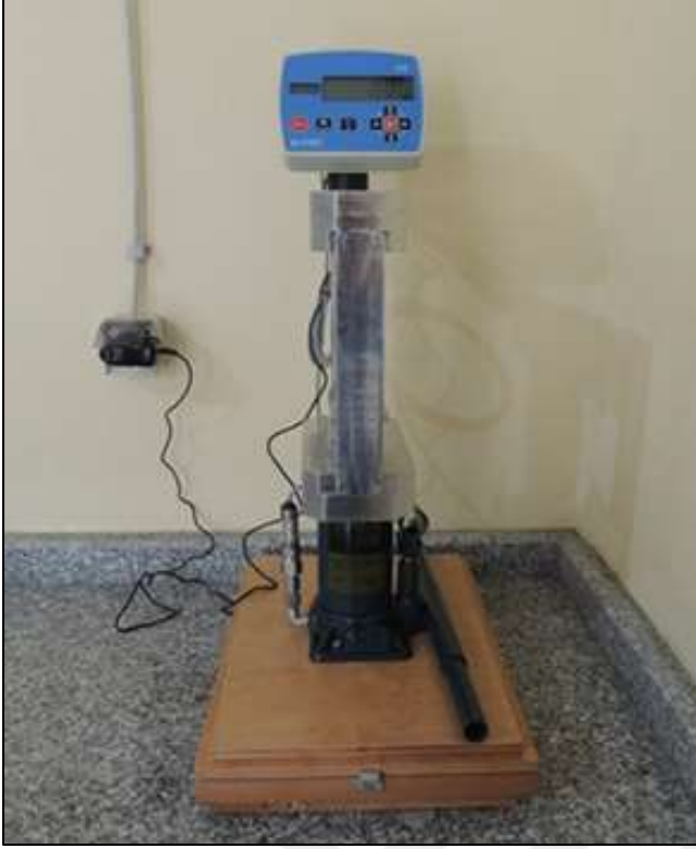
Şekil 4.16. Nokta yükü dayanım indeksi deney aleti.
