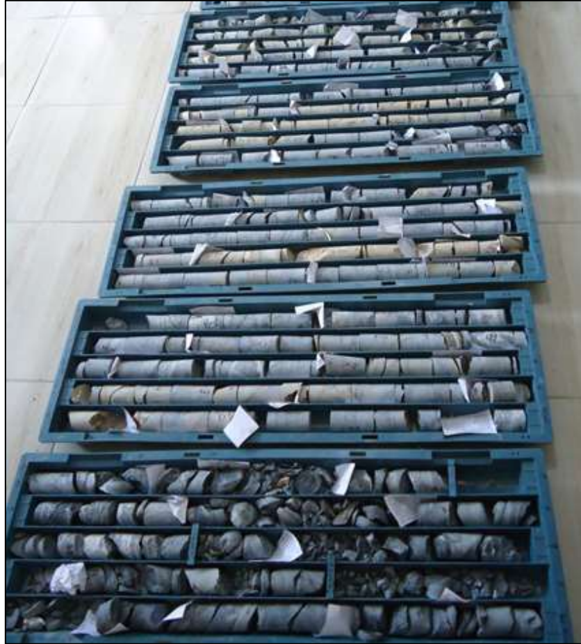
Şekil 4.4. Laboratuvara getirilen karot sandıkları.
