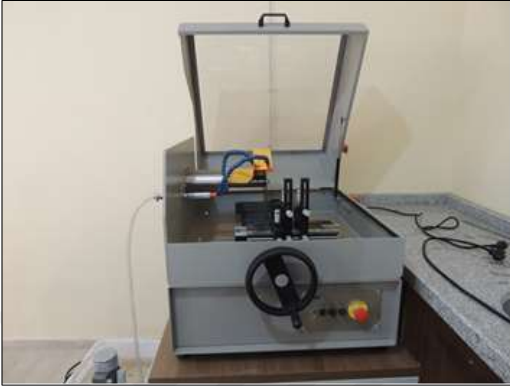
Şekil 4.10. Karot kesme ve düzeltme makinası.
