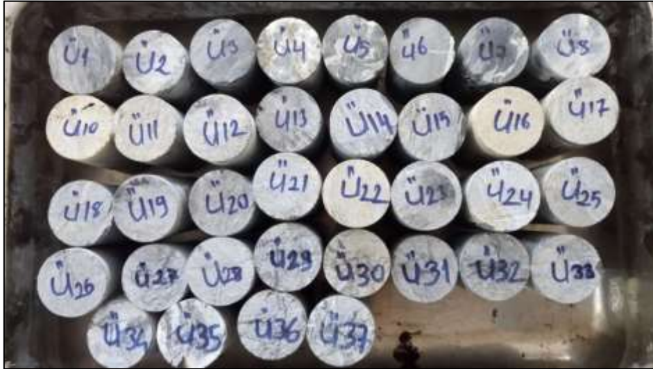
Şekil 4.13. SK-1 sondajından üç eksenli deneyi için hazırlanan örnekler.
