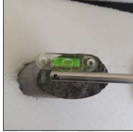
Şekil 4.6. Pürüzlülük ölçümü (üstten görünüm).
