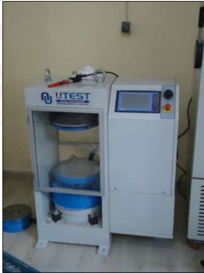
Şekil 4.19. Tek eksenli sıkışma dayanımı deney aleti.
