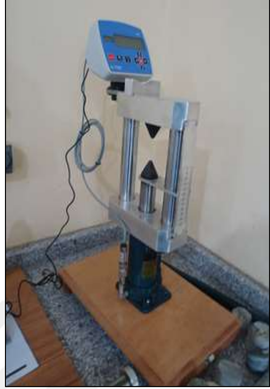
Şekil 4.17. Nokta yükü dayanım indeksi deney aleti (konik başlıklar).
