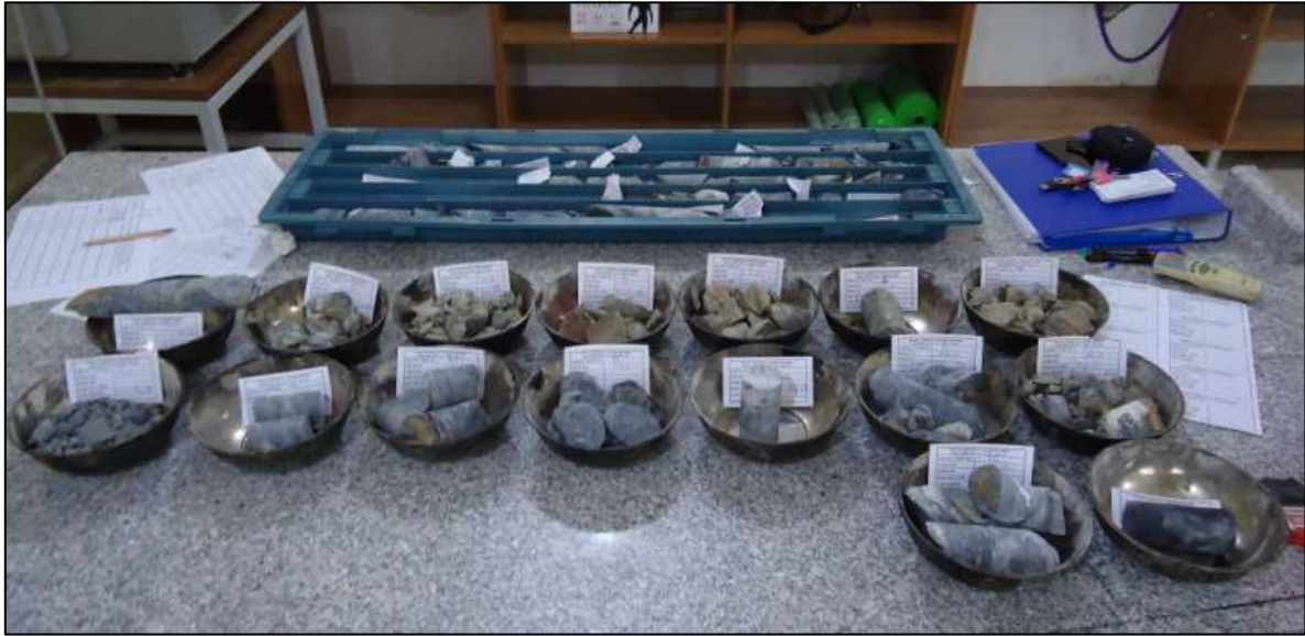
Şekil 4.14. Yoğunluk ve birim hacim ağırlık deneyi için hazırlanmış örnekler.
