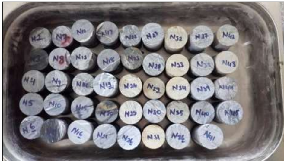
Şekil 4.11. SK-1 sondajından nokta yükü dayanım indeksi deneyi için hazırlanan örnekler.
