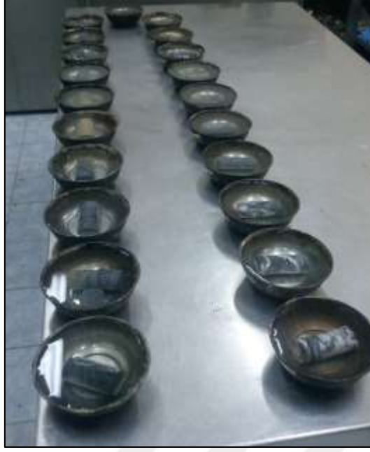
Şekil 4.15. Laboratuvardaki örneklerin saf suda bekletilmesi.
