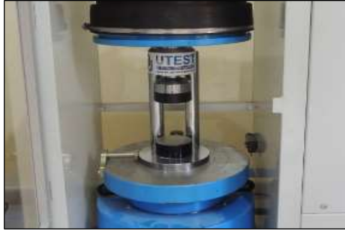
Şekil 4.18. Tek eksenli sıkışma dayanımı deney aleti (deney jigi).
