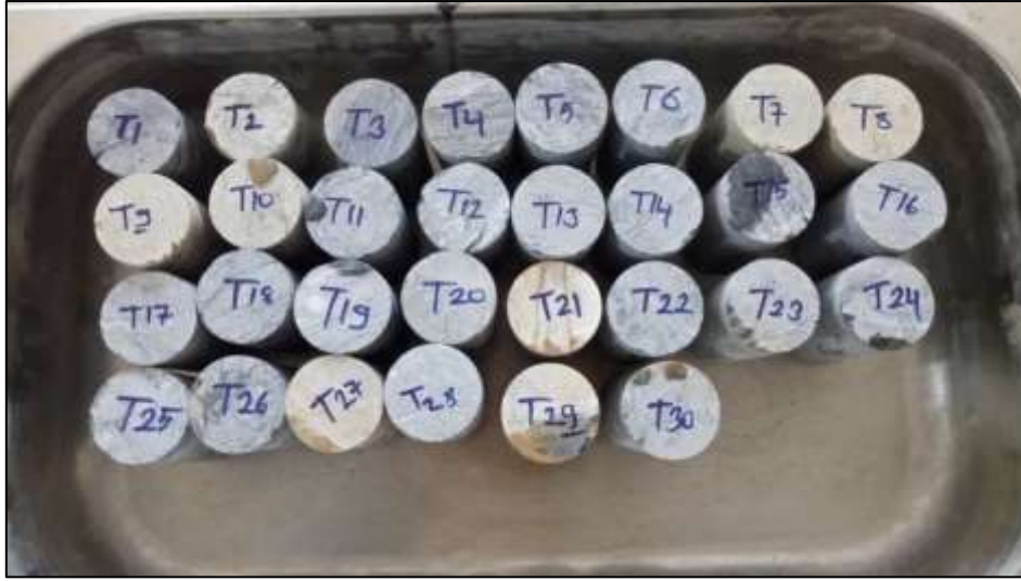
Şekil 4.12. SK-1 sondajından tek eksenli sıkıştırma deneyi için hazırlanan örnekler.
